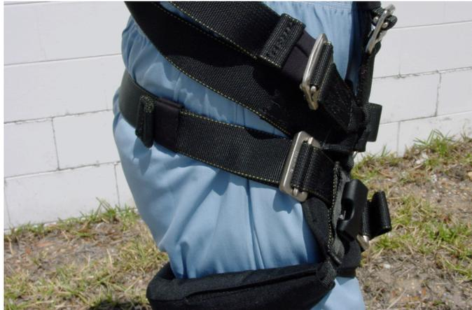
6) Serrez la sangle horizontale arrière. La partie basse du harnais devrait être ajustée et en tension.
