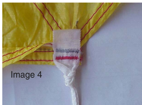
Image 4: Mise en conformité avec le bulletin de Service demande une couture bartack 42 supplémentaire à 16 endroits, une sur chacune des 8 pattes d'attache des suspentes 'A' et une sur chacune des 8 pattes d'attache des suspentes "B"
