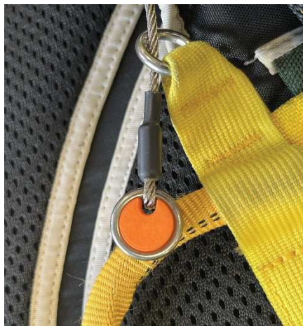
Fig. 2 – Anneau d’extrémité du câble de la poignée répéteur secours avec obturateur End ring of the reserve override ripcord cable with sealing cap
