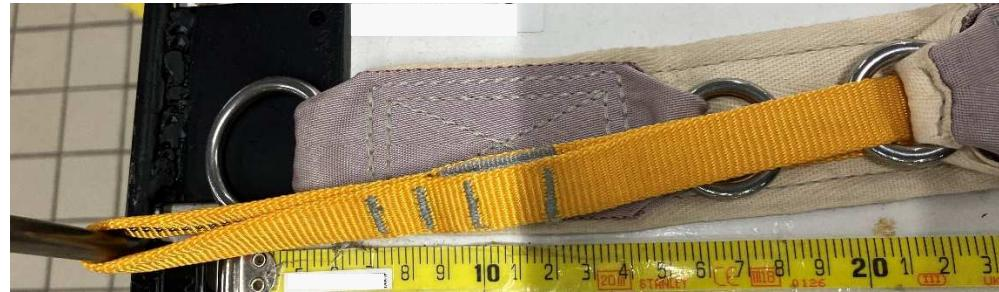
Tirer manuellement simultanément sur les deux sangles (interne et externe) en appliquant sur chacune une tension équivalente comprise entre 5 et 10 kg.
