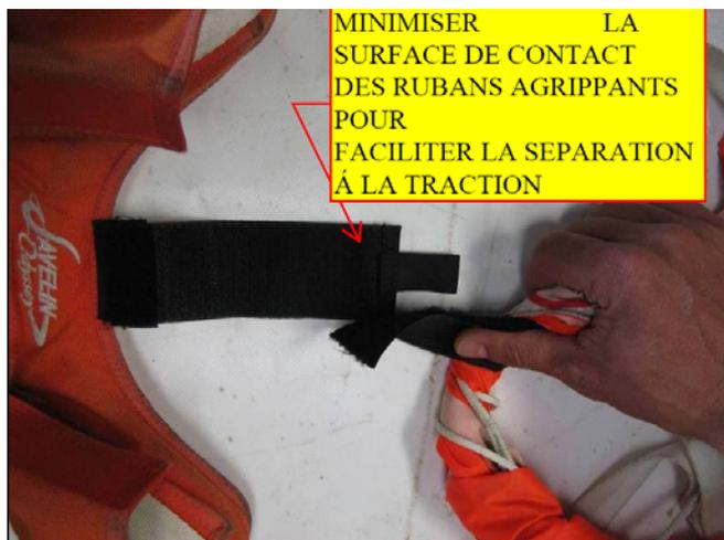
3- De s'assurer au sol que le glisseur soit séparable sous une **force de traction maximale de 5 (CINQ) Dan**
