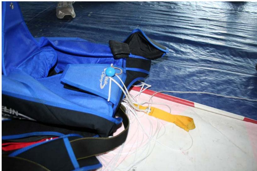
Les dispositifs installés dans le dos de la combinaison ou sur tous types de parachutes (attache par ruban agrippant) et les dispositifs par attache sandow et boule, situés au niveau de la partie supérieure du rabat de protection du parachute de secours, permettent à l'utilisateur de ne pas être gêné par le glisseur pour le pilotage de la voile.
