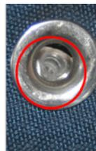
l'utilisation d'une bague plastique imparfaite est sujette à compression jusqu'à rupture
