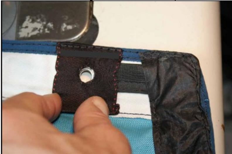
Un léger embut de la sangle doit apparaître pour dégager l'espace nécessaire à l'épaisseur du couteau du déclencheur.
