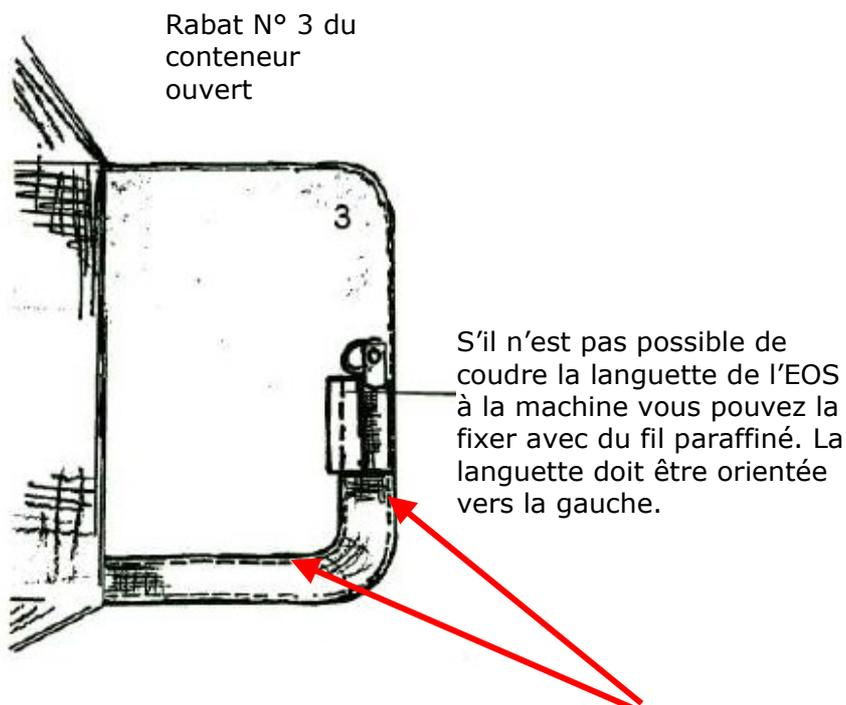
Les deux coutures de fixation de la gaine pour câble doivent être espacées d'environ 1 cm. La couture de dessous doit passer au milieu de la bande. Les fils utilisés doivent, si possible être de la même couleur que le rabat. Fixez le sectionneur et la languette conformément au croquis ci-dessus.
