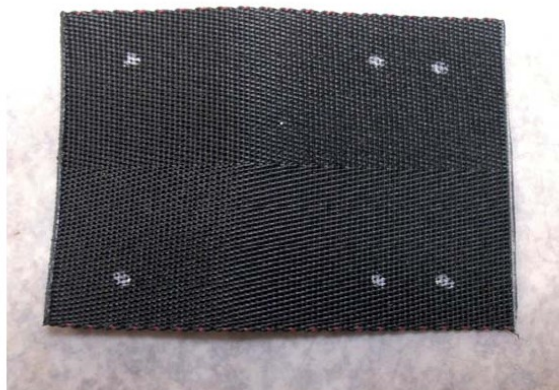
Sangle Type 12 de 6 cm pointée à l'aide du gabarit N°2
