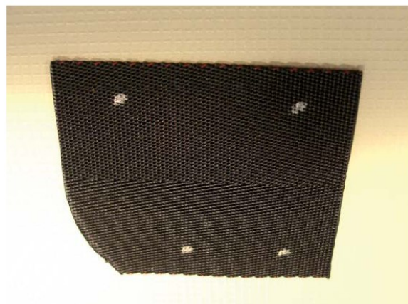
SangleType 12 de 5 cm pointée à l'aide du gabarit N°2B
