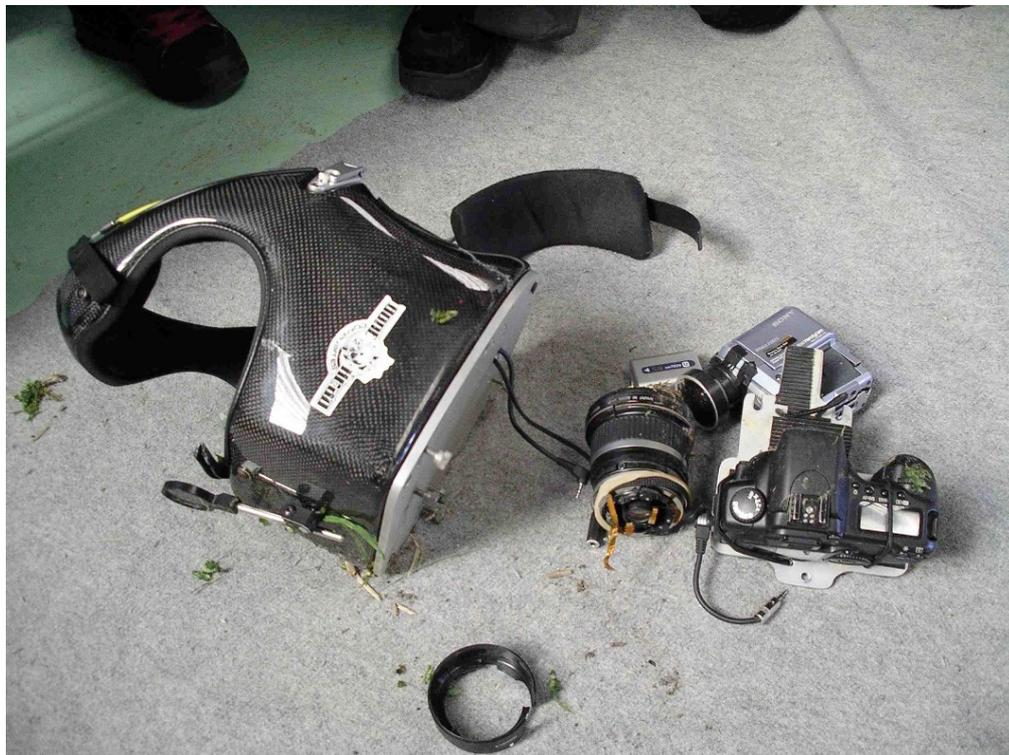
L'analyse de l'incident montre que la perte du casque est due à la rupture de l'axe métallique de la charnière coté libérateur d'urgence de casque. Cette rupture a probablement été causée par les contraintes de cisaillements lors des actions répétitives de fermeture de la coque arrière articulée prenant appui sur la nuque et bloquant le casque en position fermée.
