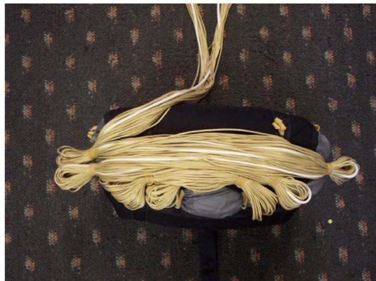
2. Séparer les groupes de suspentes en un groupe d'élévateurs gauche et un groupe d'élévateurs droits et placer ces suspentes dans le bracelet de lovage suivant du même côté du sac de déploiement, laissant approximativement 30 à 38 centimètres d'excédent entre la dernière boucle de lovage et les élévateurs.
