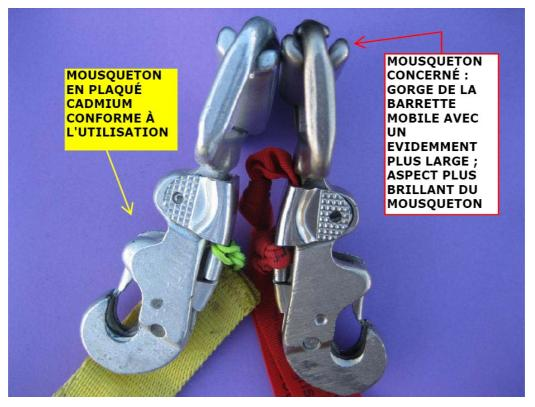
Conformément aux recommandations du constructeur de mousquetons procéder à leur changement pour un mousqueton plaqué cadmium de type MS22018 ou PS22018. Contacter le constructeur du harnais Elèves/passagers Tandem. En cas de difficulté, contacter la FFP (eric FRADET).
