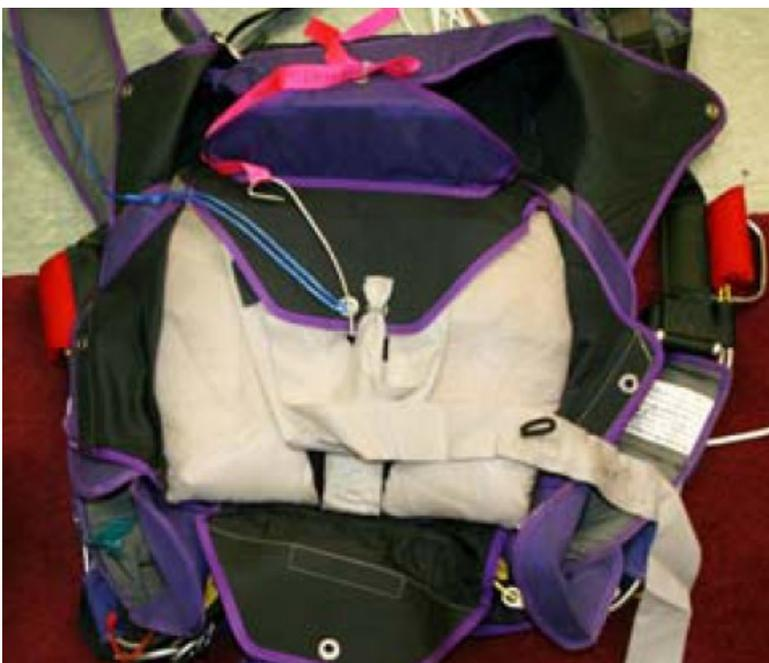
**NOTE :** à ce niveau du pliage, pliez en « S » la sangle de liaison sous le rabat n°1 selon la procédure de pliage, que le sac soit équipé ou pas d'un Skyhook.
