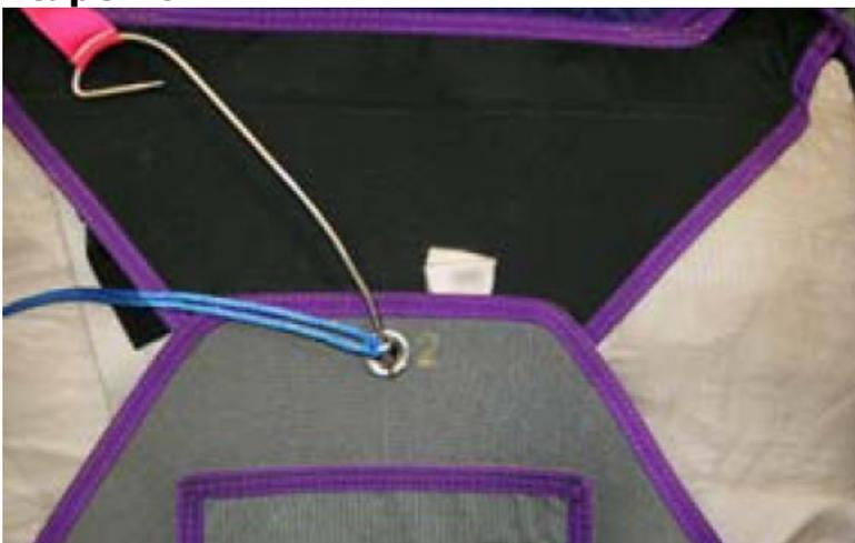
Vue de dessus après la fermeture du rabat n°2. Notez que le repli de la sangle de liaison du secours dépasse d'environ 1,2 cm du bord du rabat n°2, ce qui est considéré comme normal. Continuez à plier en appliquant la procédure standard, telle qu'expliquée dans le manuel de pliage.
