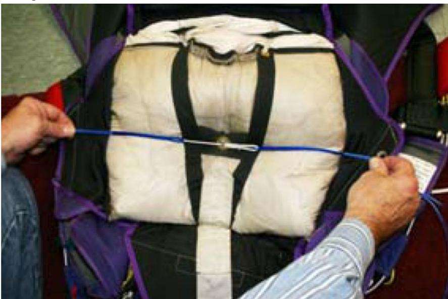
**Placer le POD de secours dans le conteneur de secours, et faites cheminer les deux drisses à travers l'œillet du POD de secours.**
