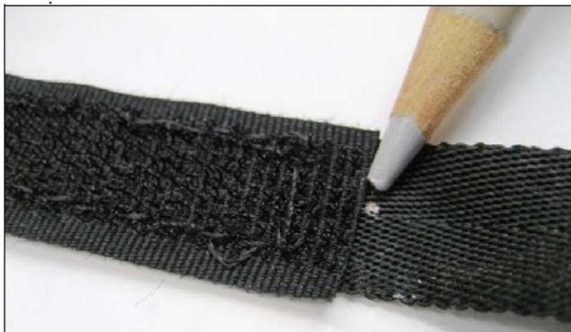
Faites un point à l'extrémité du velcro mâle qui est côté du mousqueton d'accrochage
