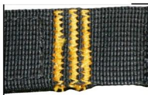
Placer les 3 bartacks en transversal du côté du bord replié
