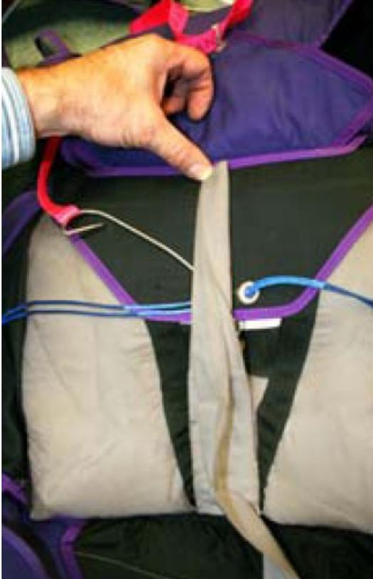
**Amener la sangle de liaison jusqu'à l'extrémité cousue du rabat n° 1 et faites lui effectuer un 180 degré tout en la repliant en deux dans le sens de la longueur comme montré sur la photo.**
