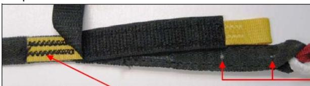
Aligner le velcro de la boucle pré-fabriquée avec la marque de l'ancien velcro et les assembler par une double couture bartack 42 points ou zig zag équivalente sur une longueur de 2,2 à 2,54 cm comme montré.
