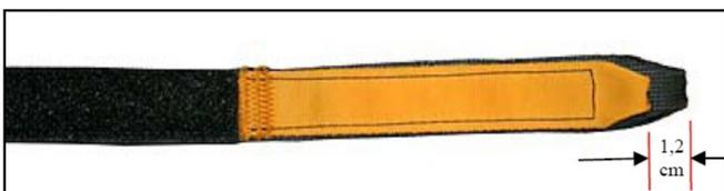
Aligner les bords repliés de la boucle terminale jaune avec le bord du velcro femelle, et installer 3 bartacks.
