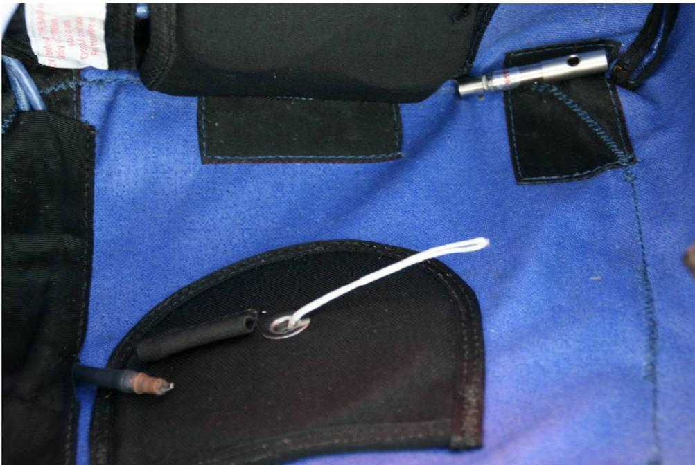
L'analyse de l'incident par le constructeur AAD, a fait apparaître que cette anomalie vient d'un défaut de sertissage.
