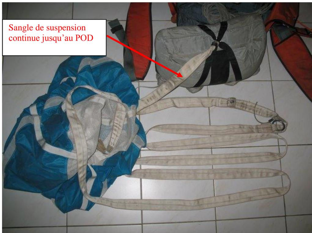
L'analyse des causes initiales a mis en avant des erreurs de pliage associées à un éventuel défaut de conception (non confirmé en l'état de l'enquête) pouvant générer le retrait progressif du jonc de fermeture du conteneur principal dès le lancer du RSE et/ou pendant la chute.
