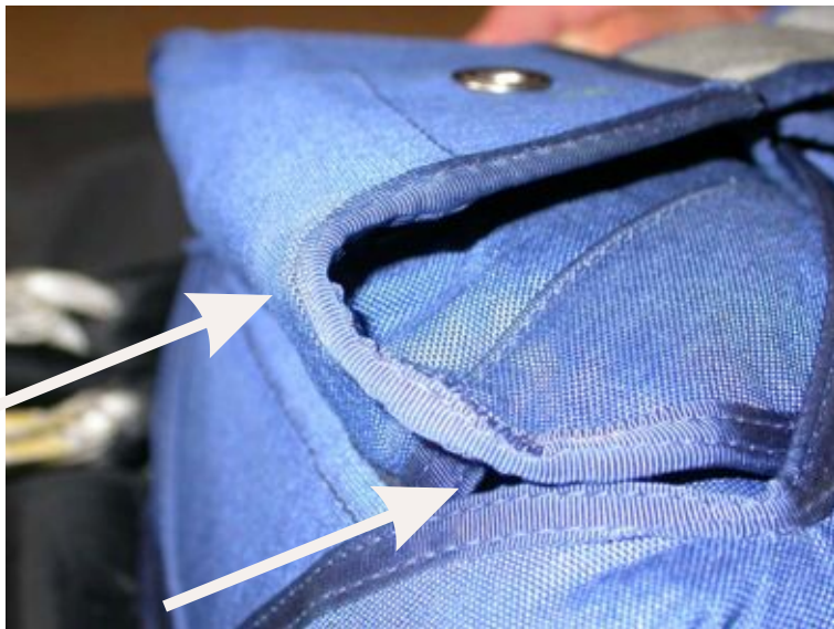
Photo 3 L'avancée du rabat et le réceptacle latéral favorisent le risque de blocage des suspentes.
