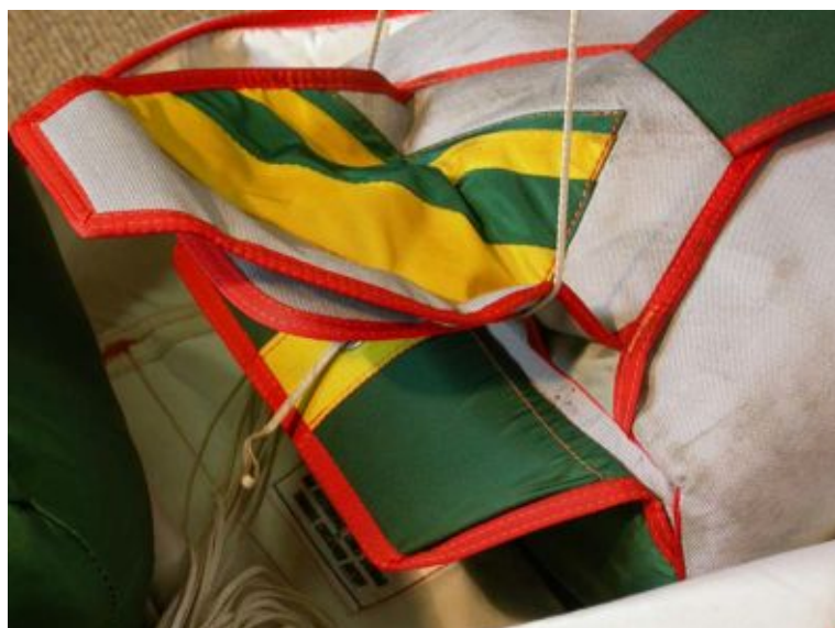
Photo 8 Blocage par suspenste coiffante.
