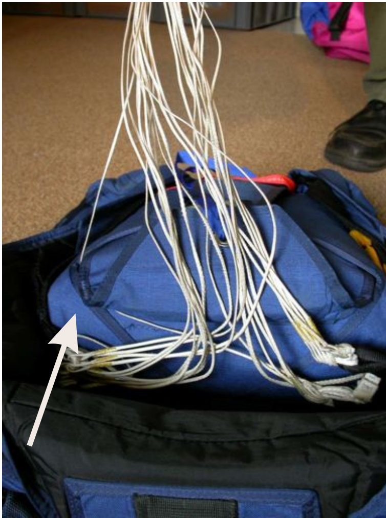
Photo 4 La suspente se coince derrière le rabat avancé et reste accrochée derrière le réceptacle latéral.
