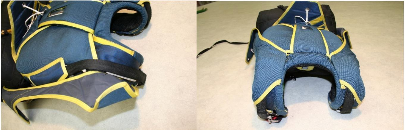
2.4/ Le sac de déploiement (POD) est correctement positionné dans le conteneur principal.
