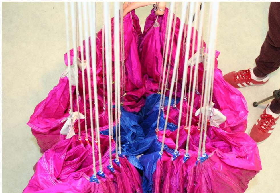
1.7/ Le glisseur est en place (en croix) au niveau des points d'attache des suspentes. Il n'est pas rétracté.
