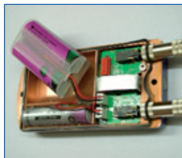
V. Brancher le nouveau Pack et le mettre dans sa cavité fils vers le haut
