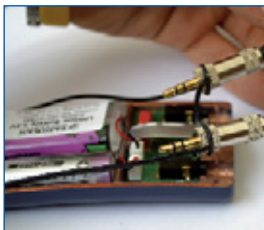
IV. Soulever le circuit et débrancher les 2 connecteurs
