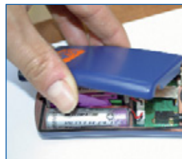
VI. Veiller à bien positionner le joint en caoutchouc. Fermer le boîtier avec les 2 vis
