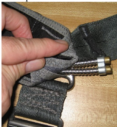
Fixation des gaines à leur base, par point sellier lié à la sangle principale avec débattement possible
