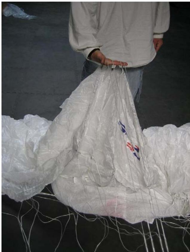
23. Prendre les suspentes A numéros 8,7,6 et 5 pour une 7 caissons (10,9,8,7 et 6 pour une 9 caissons), si vous avez des suspentes centrales directes, sur la voile : suivre la couture du bas et prendre la suspente 5B pour une 7 caissons ou 6B pour une 9 caissons. Vérifiez le cheminement continu des suspentes A et B, à travers les pattes d'oies, sur les élévateurs avants droits.
