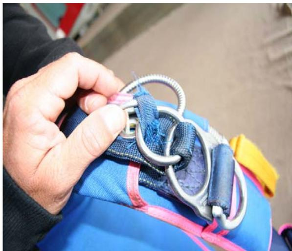
Contrôler le bon état des **petits bouclettes** verrouillant le système de libération 3 anneaux. Ils sont vulnérables et peuvent être victimes d'une usure anormale lors d'une friction sur un plan rugueux, au cours du pliage par exemple, à cause d'un mauvais montage du système trois anneaux, ou à cause de tous les frottements malencontreux.
