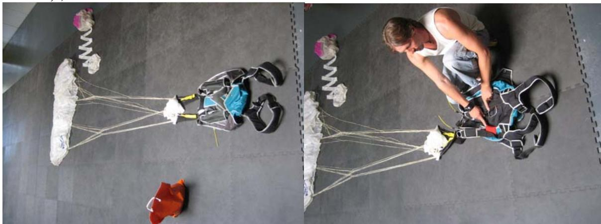
Mettre en place le déclencheur ; Mettre en place le système de sécurité passif s'il est présent; Mesurer la bouclette de fermeture
