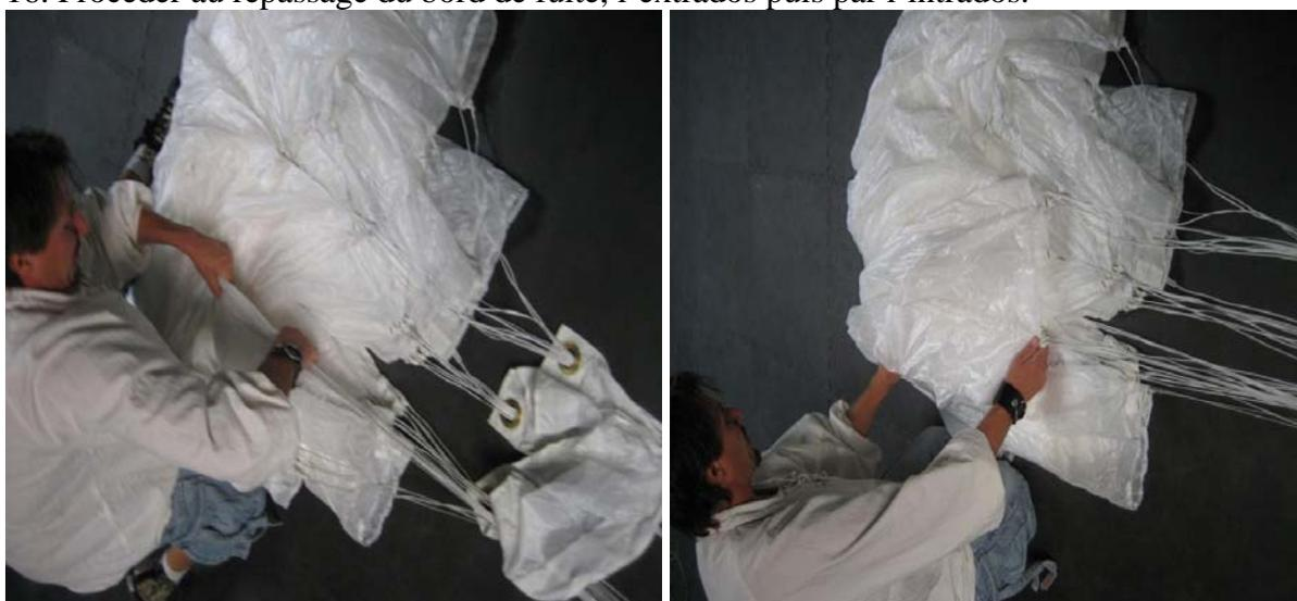
17. Se placer sur l'autre côté de la voile, maintenir la demi-voile pliée et exécuter le même mode opératoire pour passer les plis de l'autre côté de la voile.
