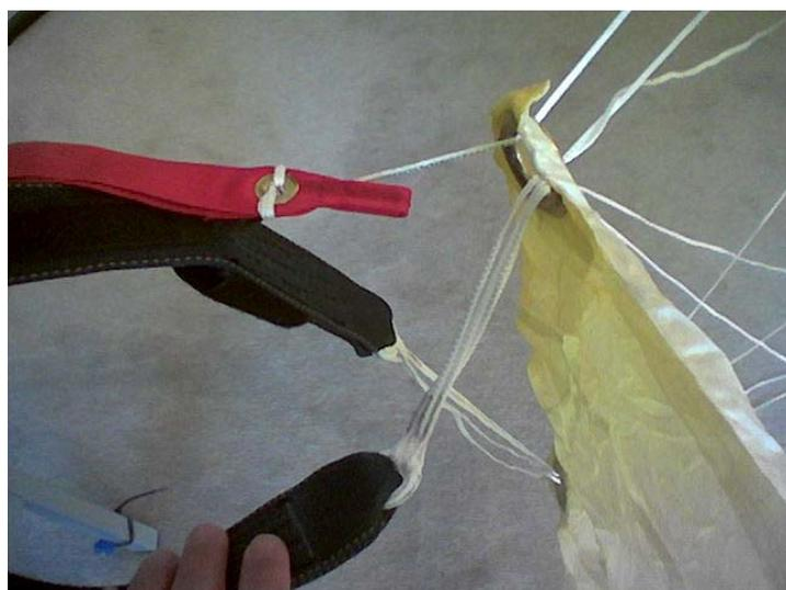
Lors du contrôle de la voile de secours, le PliEUR contrôle le bon montage de l'équipement, une erreur de montage créée par le plieur précédent deviendra votre erreur si vous ne vous en apercevez pas.
