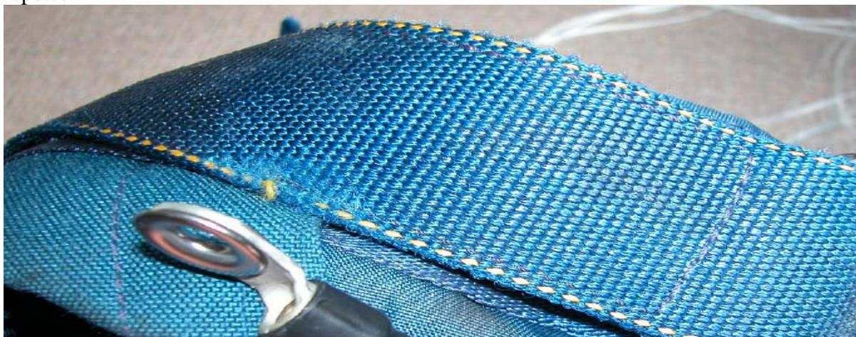
Exemple d'anomalie nécessitant une remise à niveau par le constructeur afin de ne pas modifier la définition du sac-harnais.
