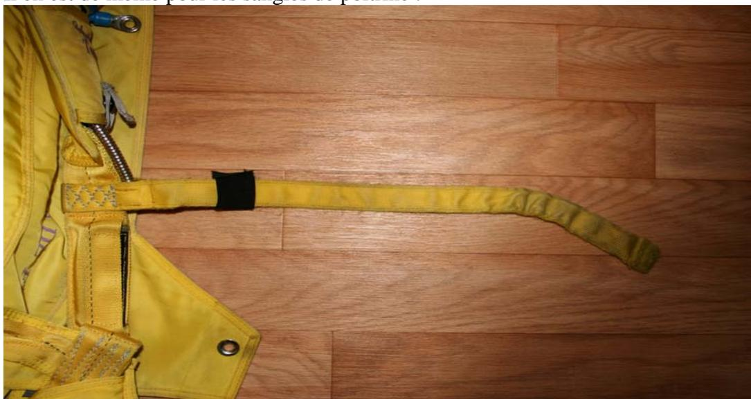
Lors de ces opérations de contrôle, il faut s'assurer qu'il n'existe pas d'anomalie de construction, dans la photo ci-dessous, absence d'une ligne de couture sur la sangle principale du harnais qui devrait être une couture 4 branches et qui est passé à travers le contrôle du constructeur :
