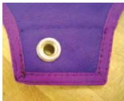
Le sens de montage des œillets doit être vérifié, en particulier pour les œillets qui viennent en dernier sur le rabat de fermeture de secours car ils subissent la pression de la broche de fermeture.
