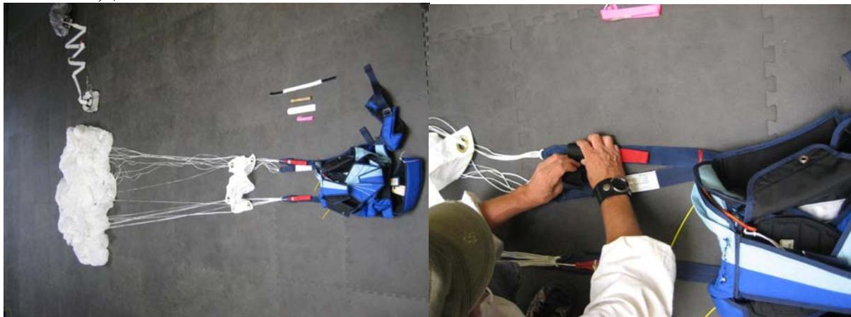
Mettre en place les sacs lestés sur les élévateurs (les avants à l'intérieur puis les arrières et enfin les commandes à l'extérieur). Attachez éventuellement les élévateurs ensemble au niveau des maillons
