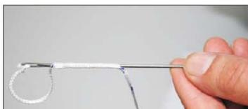
2. Faites le strapping de la petite boucle au niveau de la rondelle ( rentrer à 7,5 cm et sortir à 13 cm)
