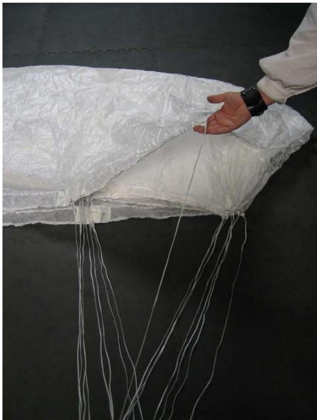
3. Trouvez le côté extérieur et la suspente d'attache A. Suivre la suspente 8A (7 caissons) ou 10 A (9 caissons), qui doit se situer sur le côté extérieur du maillon de connexion, et assurez vous que le maillon soit attaché fermement à l'élévateur droit.
