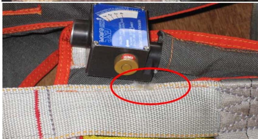
Usure de la sangle principale causée par une mauvaise conception de l'emplacement du boîtier FXC 12000 sur l'Atom Légend, les vis de fixation du boîtier FXC 12000 entament le liserai.
