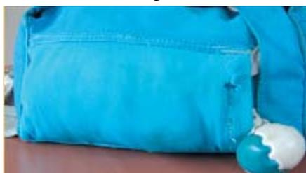
Si ses fibres sont rompues, la pochette n'enserrera plus fermement l'extracteur. Celui-ci peut alors sortir plus facilement au point de provoquer une ouverture intempestive de la voile principale.
