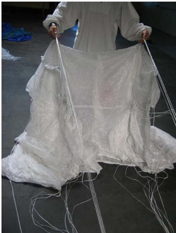
19. En tenant les suspentes 1,2,3 et 4 pour une 7 caissons (1,2,3,4,5 pour une 9 caissons) dans votre main droite et les suspentes 5,6,7 et 8 pour une 7 caissons (6,7,8,9,10 pour une 9 caissons) dans votre main gauche, vérifiez le cheminement continu des suspentes C et D à travers les pattes d'oies jusqu'à leurs élévateurs respectifs.
