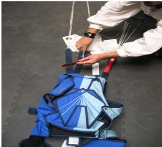
12. Retirez les torsades sur elles-mêmes tout en continuant et en suivant le bas de commande inférieur gauche jusqu'à son extrémité, en s'assurant qu'elle passe à travers l'œillet de glisseur concerné puis à travers l'anneau de guidage des élévateurs.
