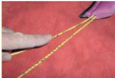
En l'absence de Silicone, le nettoyage à l'eau savonneuse suivi d'un séchage avec un chiffon ne laissant aucun fil est autorisé.
