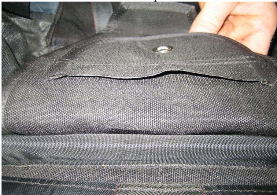
En dehors des erreurs de construction, des erreurs de montages peuvent avoir été commises par un plieur précédent, **si c'est le cas, son erreur devient la vôtre si vous ne la détectez pas.** Exemple : mauvais cheminement de la gaine de commande de secours qui devrait passer dans la sangle de poitrine :
