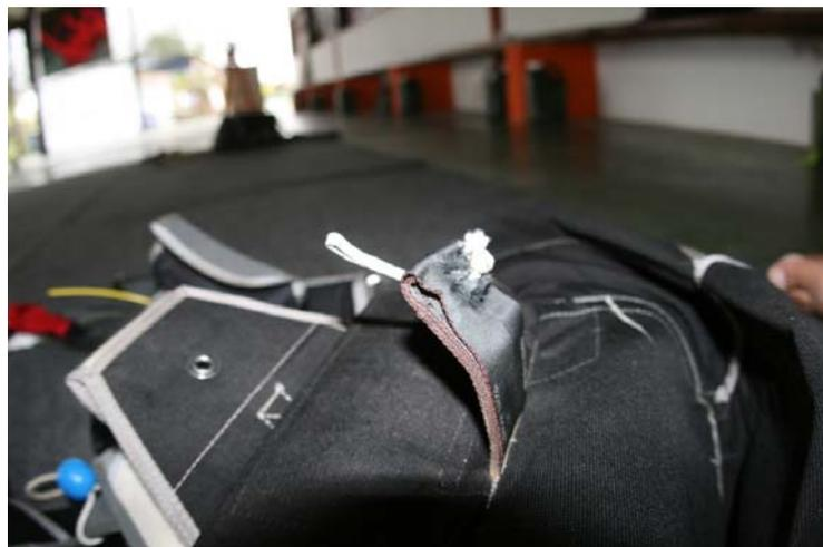
mais également le nœud d'arrêt de la bouclette de fermeture ne doit pas être trop proéminent car les double nœuds créent une surépaisseur qui augmente la friction au contact du sac de déploiement et traversent la sangle de type 12 qui sert de support de bouclette.
