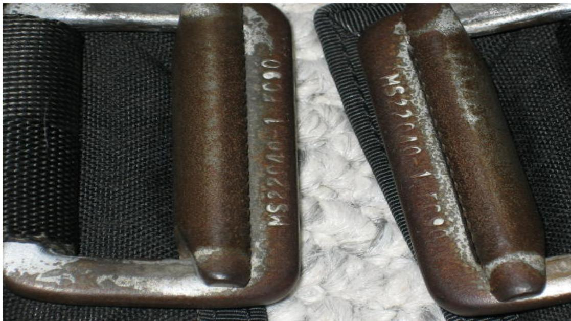
Si le problème est causé par deux pièces de métal au contact l'une de l'autre, la situation est plus grave, car la dégradation va empirer, au point que les deux parties peuvent même sous certaines conditions fusionner ensemble, dans ce cas les parties corrodées doivent être remplacées.
