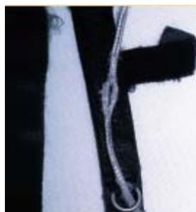
Des velcros en mauvais état peuvent facilement s'ouvrir en chute, et ainsi devenir dangereux en fonction du type de saut et de l'endroit où ils sont placés, il faut donc les remplacer avant qu'ils ne soient trop usés.
