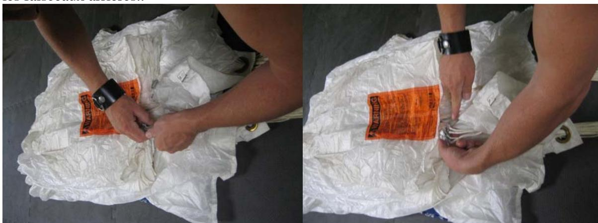
Dégager les coutures du bord du caisson central en l'écartant et descendre le bord de fuite en tenant l'insertion des « D » jusqu'à ce que le bord de fuite enveloppe le glisseur
