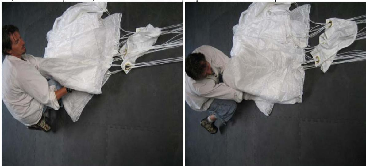
14. Procéder à l'identique pour le pli C/D. Les plis doivent être à plat et ne doivent pas présenter de vrille.
