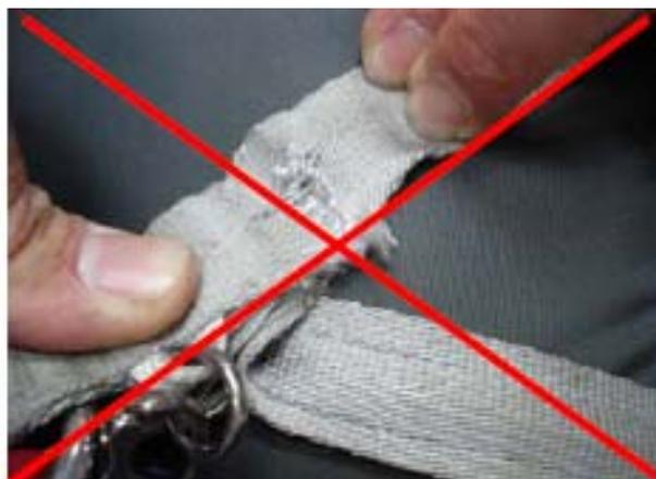
Vérifiez que la bouclette de verrouillage des 3 Anneaux est bien solide et pas usé, la cause peut venir des parties saillantes de l'œillet d'élévateur ou d'une agression par frottement de la cosse de gaine de libération, c'est pourquoi il est important de vérifier cette partie.
