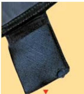
couvrant les aiguilles de fermeture. Contrôler que les renforts en plastique dur à l'intérieur de ces pattelettes ne soient pas cassés, les pattelettes de fermeture des conteneurs principaux ne doivent pas être déformés ou usés, une fois usé le frottement de la plaque de plastique qui rigidifie la pattelette peut entamer le tissu.
