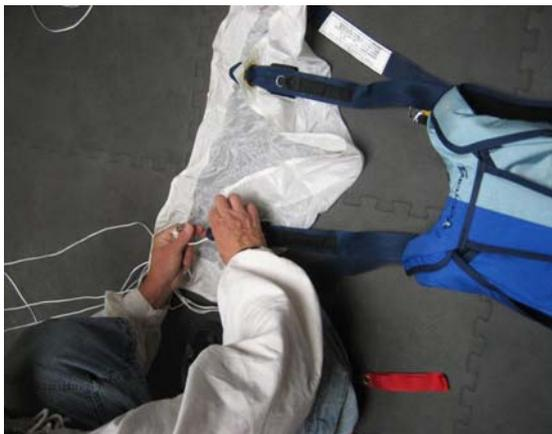
4. Pour connecter les faisceaux arrière, procéder comme pour le bord d'attaque, mais en saisissant les suspentes arrière.
