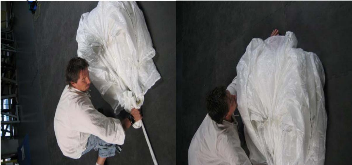
12. Se porter sur un côté de la voile et basculer le côté de la voile dans l'axe du faisceau de suspentes.
