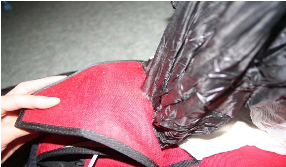
La couche d'uréthane appliquée à l'origine pour protéger le cordura peut se dégrader en s'épluchant de cette manière, sur du long terme la dégradation de la couche d'uréthane affecte la trame du parachute et celui-ci doit être mis hors service.
