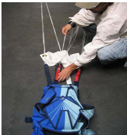
11. Retourner au panneau comme point de référence, trouvez et prendre la commande de manœuvre gauche et vérifier la continuité de la jonction des brins de commandes supérieurs au brin de commande inférieur.
