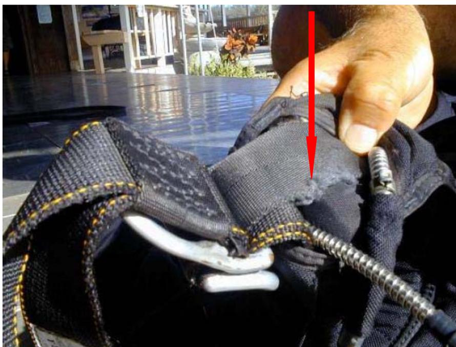
descente sous voile des expositions répétées à l'abrasion couperont par usure les fils des sangles et des rubans. exemple d'usure progressive provoqué par une oreille de collier oetiker dont le sertissage était en contact avec la sangle diagonale de type 8. La friction de gaines de libération ou/et de secours lors de chaque ouverture dégrade également la sangle lorsque ces gaines ne sont pas canalisées par un tunnel ou protégées
