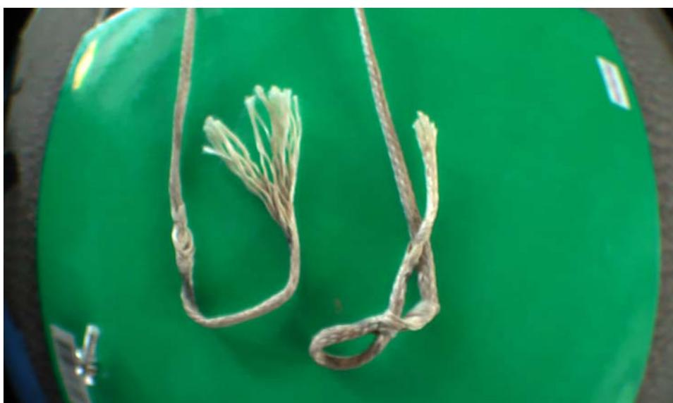
un strapping mal effectué (trop court et pas cousu) et mal contrôlé abouti à une situation où la liaison mécanique n'est plus assurée avec risque de séparation, les contrôles doivent donc porter sur la bonne exécution de ces coutures.
