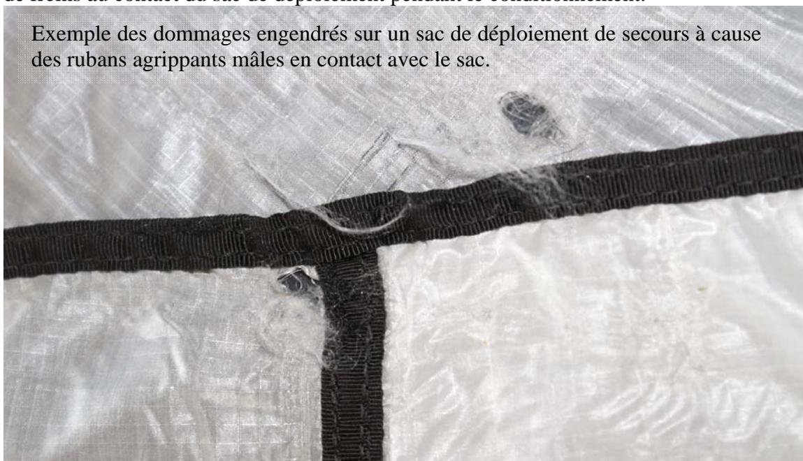
Vérifiez que le velcro de la pochette de pliage adhère correctement et ne montre pas de signe d'usure, si le ruban agrippant ne tient pas fermement, il peut se produire un effondrement des suspentes durant la phase d'ouverture, pouvant provoquer un incident dû au désordre de la cinématique d'ouverture.
