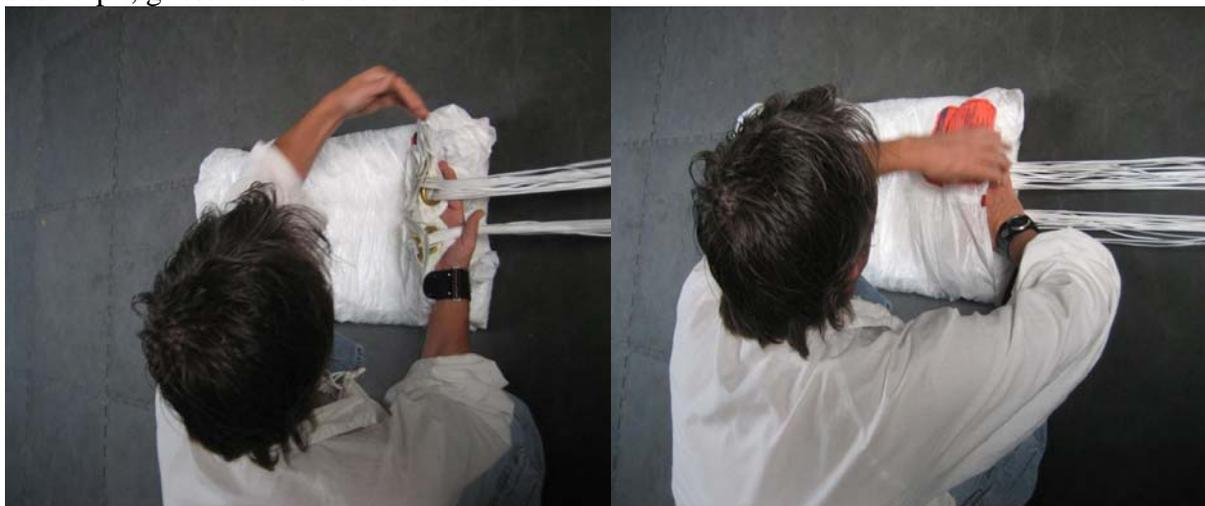
23. Placer le POD à côté de la voile au niveau des œillets du glisseur. Poser les genoux sur le premier S. Relever la voile et se servir des cuisses comme plan de travail.
