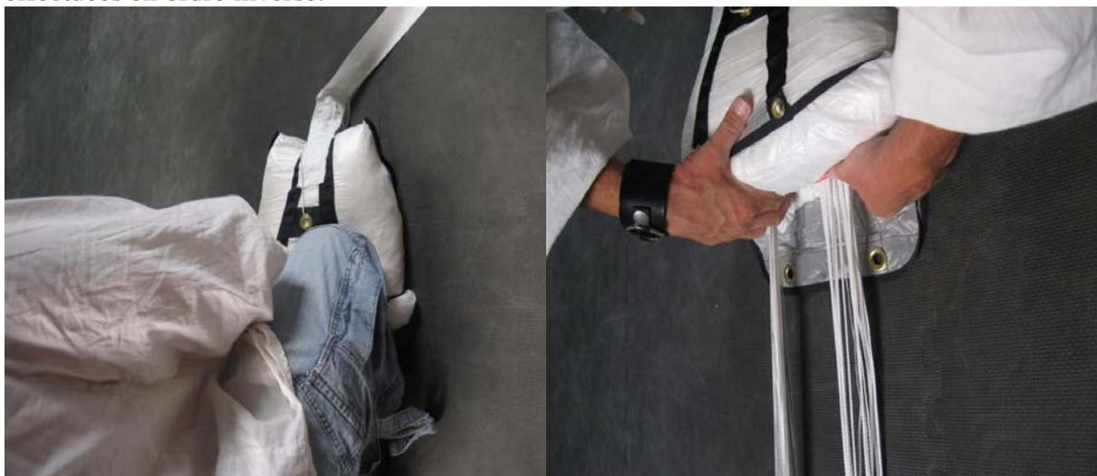
33. On doit avoir au même niveau (ouverture du POD) dans l'ordre du haut vers le bas : le pli supérieur, le bord de fuite, les œillets de glisseur (espacés de la largeur des œillets du POD)
