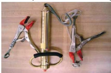
Ces deux pinces pour le tissu sont nécessaires avec des mâchoires où est disposé un espace plat capitonné de caoutchouc pouvant capturer 2, 5 cm<sup>2</sup> et à l'extrémité de la poignée principale est disposé un anneau souvent par soudure, un pèse personne étalonné jusqu'à 22 kilos est également nécessaire.
