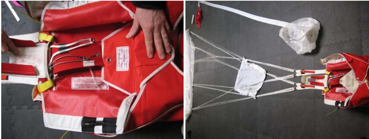
3° Saisir au dessus du glisseur les faisceaux de commande un par un et les dévriller en remontant vers le sac.
