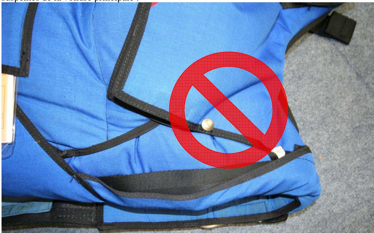
Montage de pression sur les élévateurs de secours d'un sac Javelin
