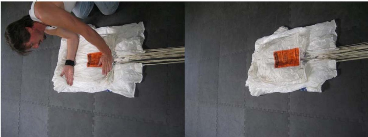
13. Remonter le glisseur et le placer par dessus le faisceau. Les quatre œillets sont dans le même sens contre les butées de glisseur (cas le plus fréquent). Si le constructeur le permet, le placement du glisseur dans le faisceau est préférable.
