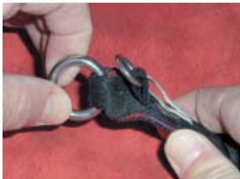
Avant le remontage, il faut **assouplir la sangle** sur laquelle sont fixés les anneaux en vrillant celle-ci au niveau du point d'attache des anneaux de gauche à droite entre les doigts afin que le tissu ne se raidisse pas. Un raidissement peut entraîner un ralentissement ou même entraver complètement le processus de libération.
