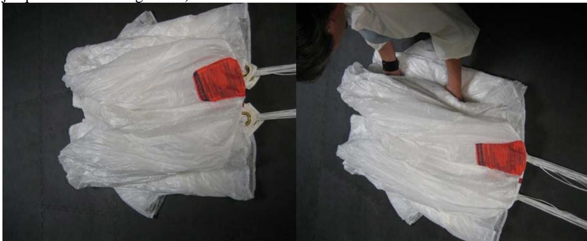
20. Relever les plis A/B, B/C et C/D et les replier en deux chacun sur eux même vers le sol. Envelopper la voile, sans le bord d'attaque qui reste contre le sol, avec le bord de fuite du caisson central.
