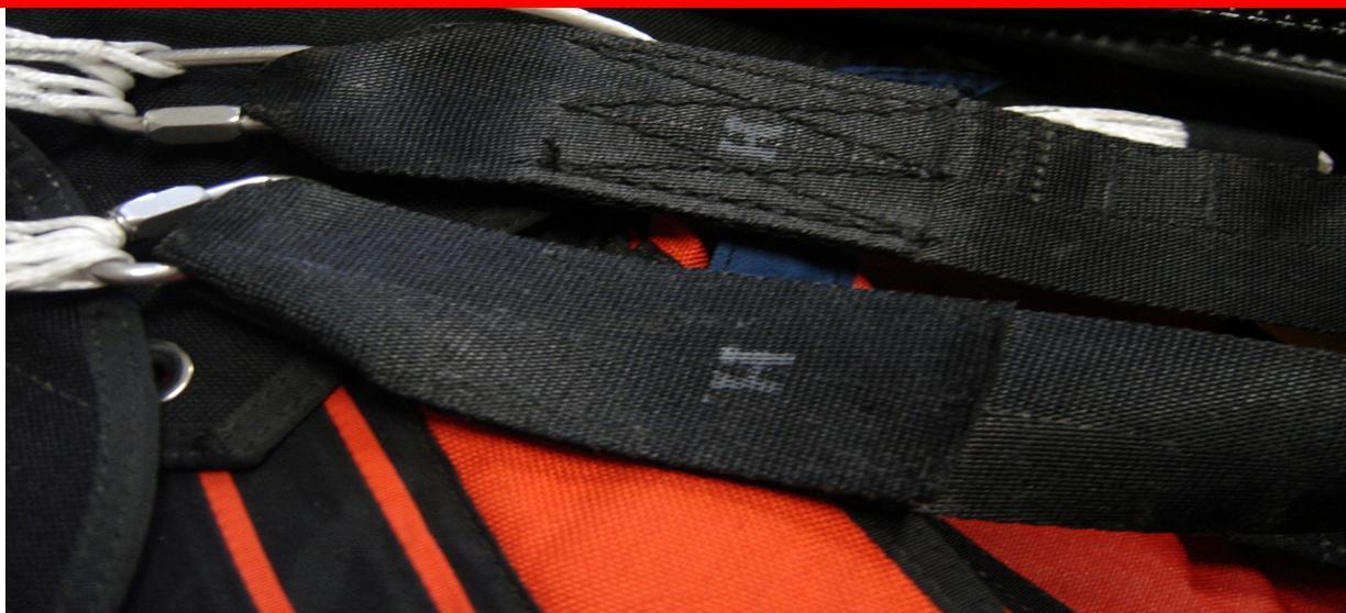
Un cas de rabat supérieur du conteneur principal d'un Atom 34 non conforme à la définition, (non galonné au niveau de la couture) fabriqué comme prototype puis mis sur le marché, nécessitant retour chez le constructeur pour remise à niveau.
