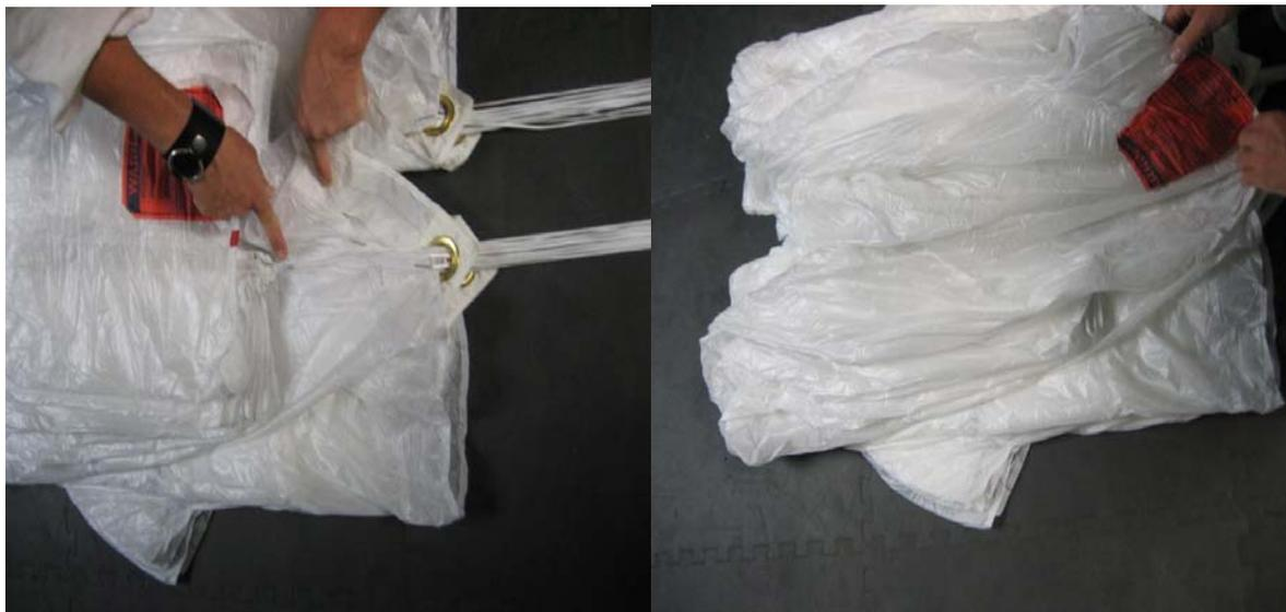
19. Dégager les coutures du bord du caisson central et descendre le bord de fuite sans détendre les suspentes « D » (selon le type de voile, cela possible de descendre le panneau jusqu'aux œillets du glisseur).
