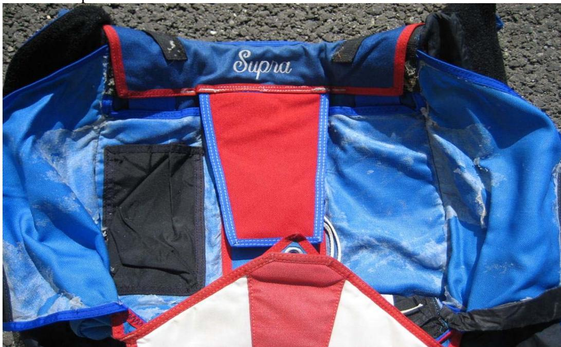
Les phénomènes de collage sont également présents sur les sacs de déploiement de secours (PdF, Sunpath), au fil du temps l'enduction se dégrade et des adhérences de la face interne du POD peuvent apparaître sur la voile.
