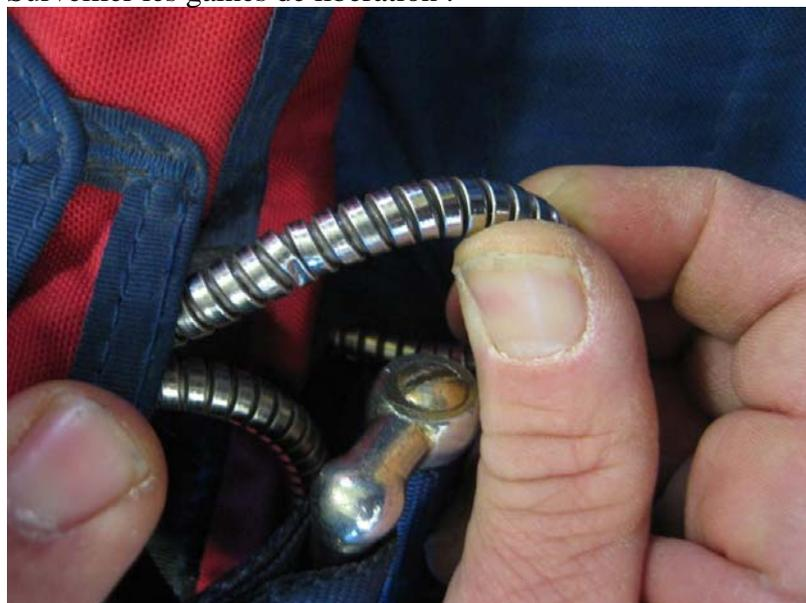
Il faut remonter sur toute la longueur des gaines de libération, à la recherche d'une cassure de la gaine, en particulier au voisinage d'une bouclerie métallique, situé à un emplacement caché.
