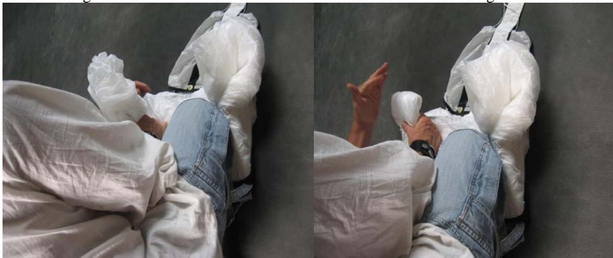
30. le relever et placer le bord d'attaque des trois caissons gauche ainsi que le caisson central sous le premier S. Replier le boudin en deux. L'extrémité du repli doit être contre le premier S.
