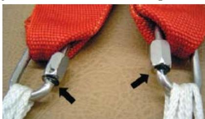
Lorsque des maillons de connexion de type vissables sont utilisés, il faut vérifier si leur taille correspond à ce qui est autorisé, l'orientation du barillet et le serrage doit être identique, il faut être certain qu'ils sont fermés correctement, et pour les voilures principales qu'ils sont protégés par un protège maillon : une pièce de plastique pour les empêcher de tourner ou une pièce en tissu qui les
