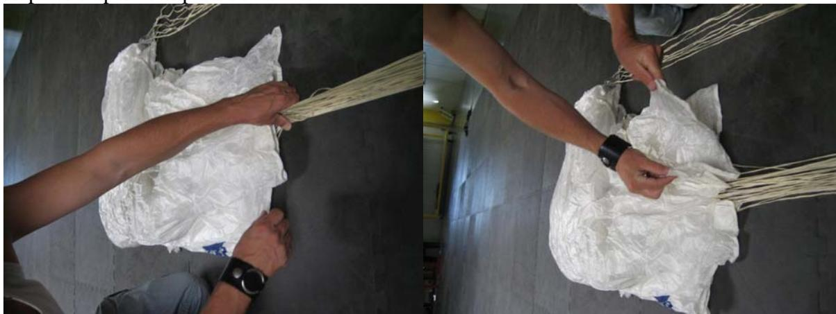
10. Vérifier la symétrie des bords des plis par rapports aux faisceaux à l'intérieur de la voile, ainsi que l'alignement des faisceaux.
