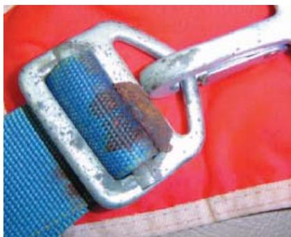
Toute bouclerie corrodée qui en contact avec de la sangle doit être remplacée, cette situation se retrouve souvent lorsque le matériel a été immergé dans de l'eau salée et mal rincé, la bouclerie va rouiller à l'intérieur de la cuissarde provoquant une usure prématurée.
