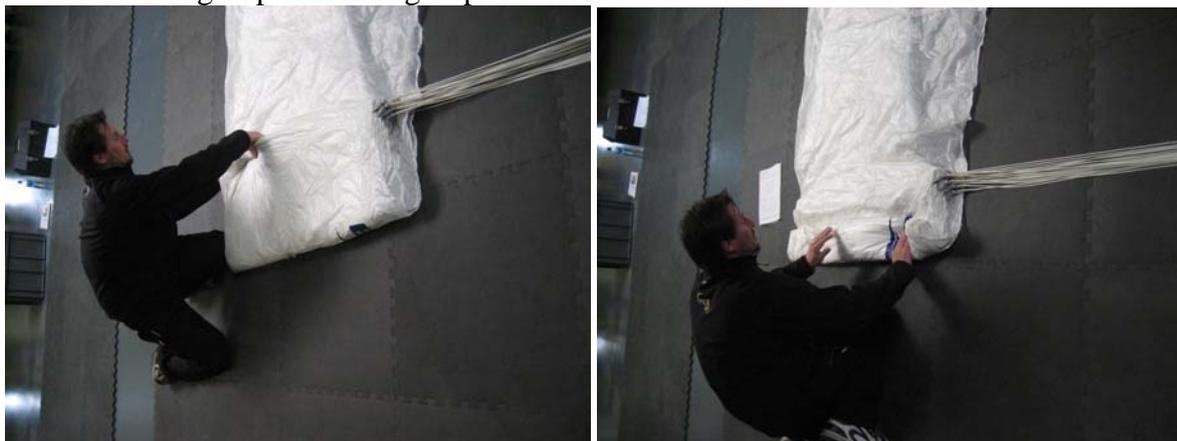
8° Replier la voile sur les groupes de suspentes superposés A et B en plusieurs fois si nécessaire selon la taille de la voile, puis mettre du lest pour maintenir le pli roulé en place.
