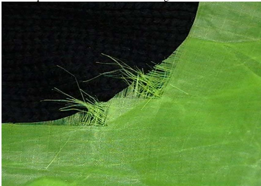
Le seul moment où cela nécessite un empiècement est quand la dégradation se dirige vers la couture. Dans la situation ci-dessous, il faut pratiquer une intervention avec un fer à chaud pour sceller les fibres, il n'est pas souhaitable d'élargir trop les intercommunications car cela peut modifier la forme en ayant les trous trop larges.
