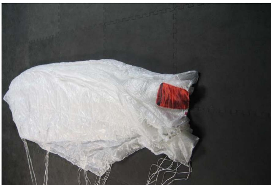
6. Tournez le côté exposé de la voile sous le reste de la voile (ou bien passez le bord de fuite par dessus le bord d'attaque), séparez la section supérieure avec ses groupes de commandes de manœuvre associés pour rendre les groupes C et D facilement accessibles pour vérification de leur installation et de leur cheminement.
