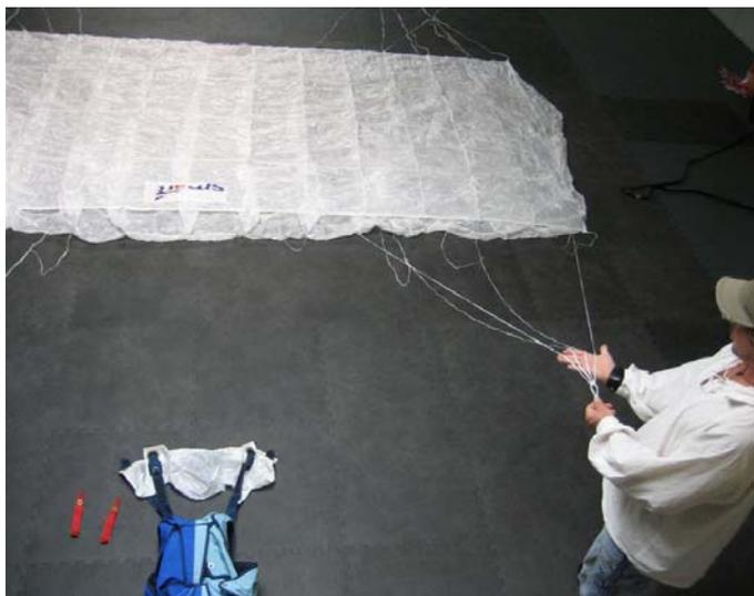
3. En se servant des mains comme de peignes, placer les suspentes avant du côté droit ou gauche entre les doigts, passer les pattes d'oies et descendre vers l'extrémité des suspentes.
