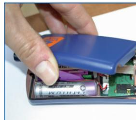
VI. Veiller à bien positionner le joint en caoutchouc. Fermer le boîtier avec les 2 vis
