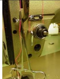
Ressort de rappel placé hors du bloc de tension
