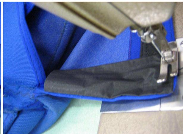
Vous êtes à même d'obtenir le même résultat en utilisant de la gaine faite à partir de galon de type III à la place de la gaine auto-adhésive Airtec et l'utilisation de couture faite main pour positionner le support de sectionneur si votre machine ne peut pas traverser la platine :
