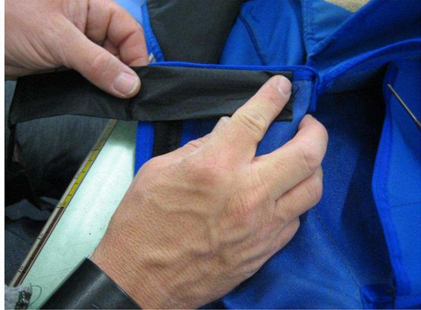
Couper la longueur de gaine, faites un repli puis faire une marque avant de faire un trou de passage de câble en face de l'orifice du support de sectionneur.
