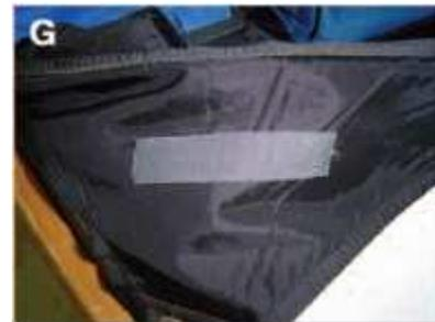
2.3.3 Coudre le contour extérieur du galon en utilisant du fil de couleur similaire au tissu du conteneur. Si c'est nécessaire, augmenter la tension du fil supérieur de telle manière que le fil du bas montre une tension idéale.
