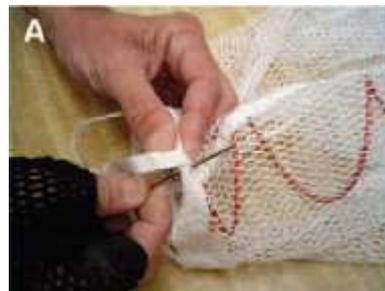
1.2 En croisant le point, traverser le galon de renfort et passer de nouveau l'aiguille à travers le galon de renfort à la base pour capturer la spire du ressort une seconde fois (Figure B).
