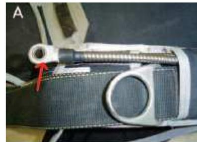
2.3 Aligner les extrémités de gaine de libération (côté poignée) et les fixer comme à l'origine. Cela peut être soit avec un double collier (figure B) ou des tacking. La figure C montre une méthode caractéristique de point de Sellier pour fixer les gaines de libération ensemble.
