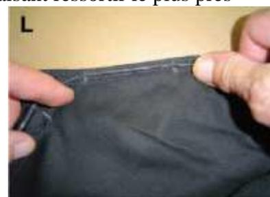
2.10.7 Retirer complètement le Cypres du conteneur. Positionner le manchon élastique sur les marques et coudre en place avec une machine zigzag. (Figure O).
