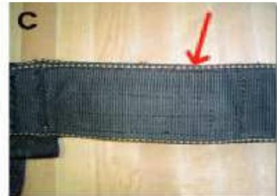
2.4 Recoudre la pochette avec deux lignes de couture à la machine simple aiguille et du fil à 4 kg (figure C).
