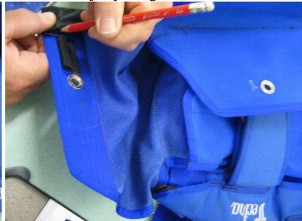
Ajuster la gaine bord à bord du galon, la gaine doit être collée puis cousue en commençant par le bas du guide du sectionneur jusqu'à l'extrémité de la gaine qui s'arrête 2 cm avant l'angle entre rabat 1 et rabat 3 (les fils utilisés doivent si possible être de la même couleur que le rabat).
