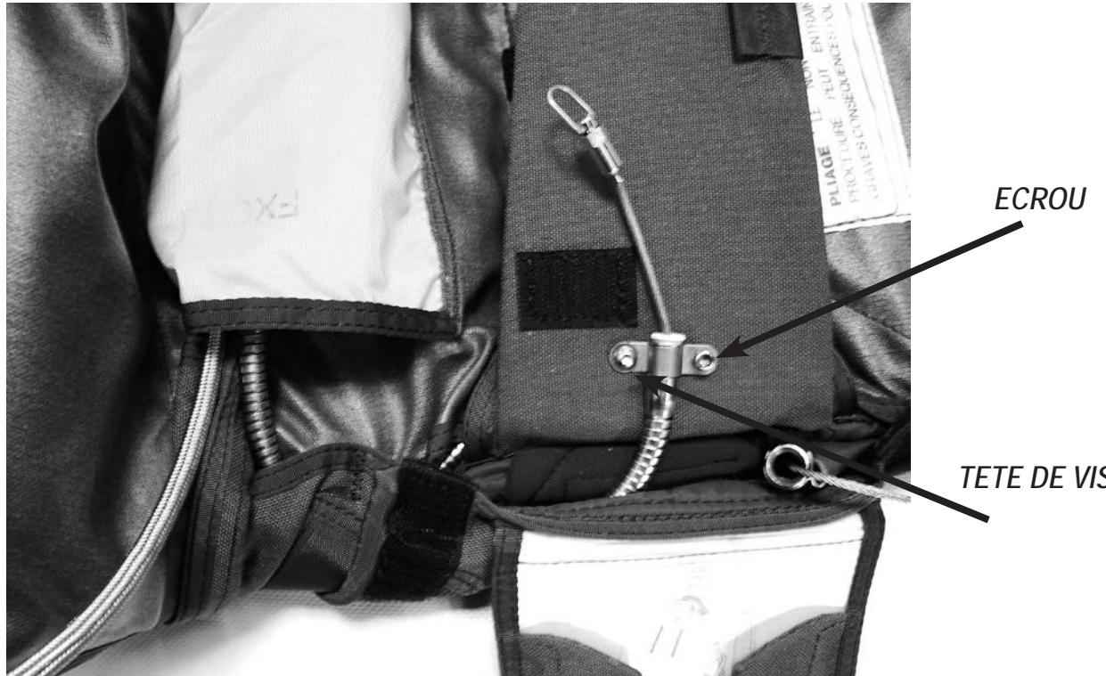
Recouvrir les écrous avec le velcro fourni.
