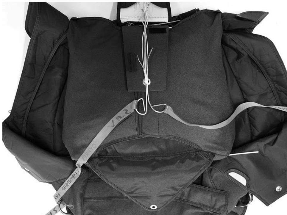
Fermer le rabat supérieur. Disposer les éléments de fermeture comme figuré ci-dessous et passer l'anneau du répétiteur dans le câble de la poignée réserve, puis introduire la broche dans le gousset de positionnement.
