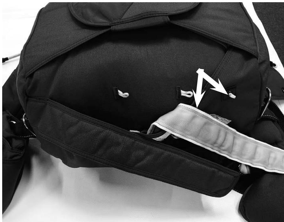
Passer le cable de verrouillage de la pochette dans le pontet prévu à cet effet.
