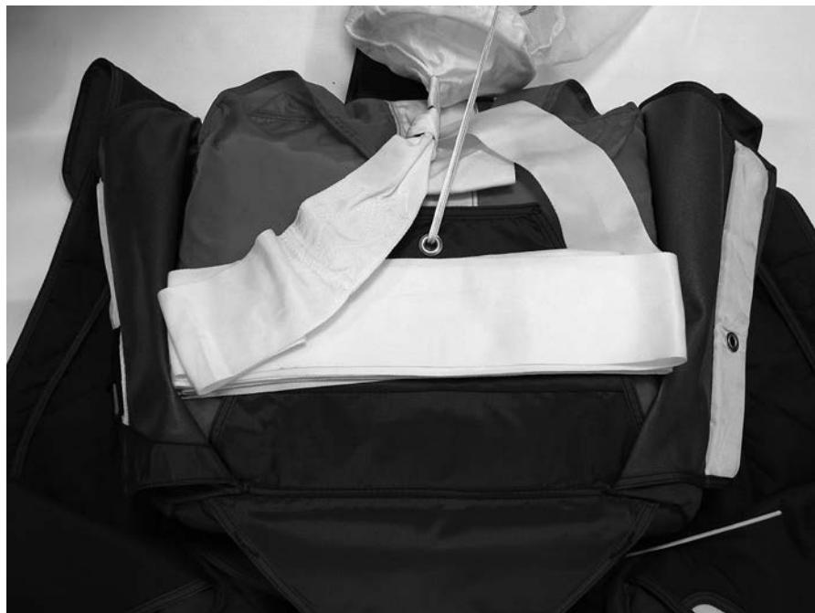
Comprimer l'extracteur spire par spire en sortant le tissu à l'extérieur et verrouiller l'extracteur à l'aide des broches provisoires..
