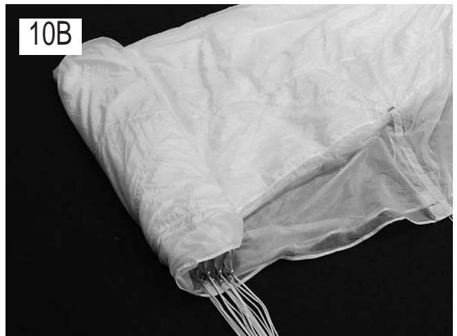
Plier la queue de la voilure en superposant les caissons
