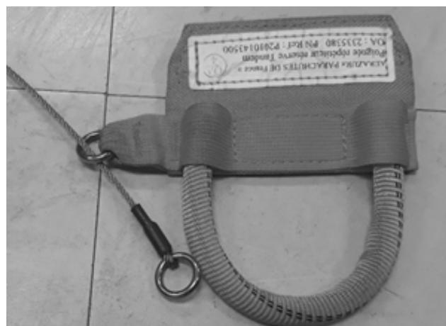
Introduire le cable de la poigénie dans le tunnel textil prévu à cet effet en veillant à placer l'anneau d'extrémité du câble sous le corps de poignée.
