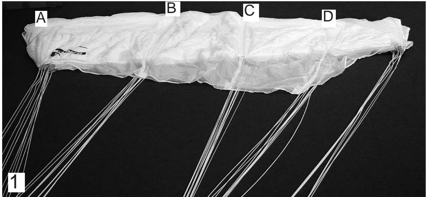
Vérifier que chaque commande est parfaitement détorsadée, puis effectuer l'opération de freinage de la voilure selon la méthode expliquée dans les pages suivantes.
