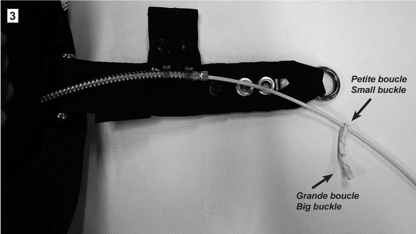
Passer la petite boucle du loop double dans le cable de la poignée pilote puis passer le cable dans le pontet prévu à cet effet. Si le cable n'est pas passé dans le pontet le loop double sera perdu après l'ouverture.
