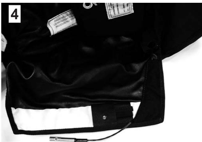
Passer le sectionneur dans le tunnel élastique, et amener le trou de ce dernier sur l'oeillet du rabat.
