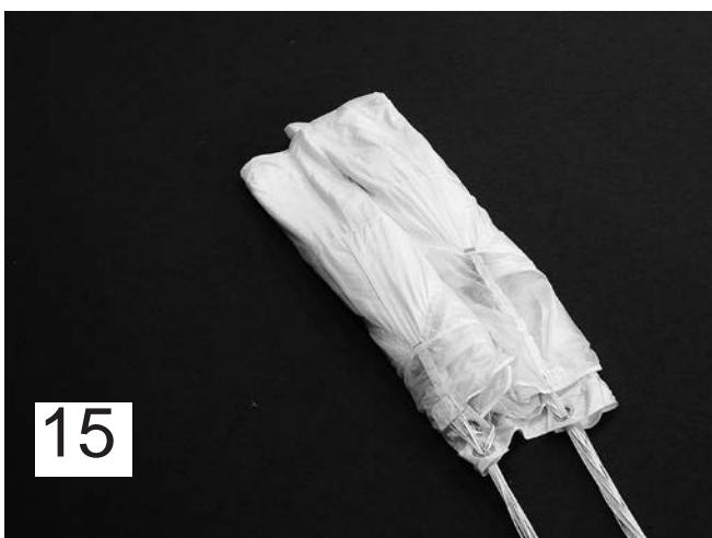
Ajuster les derniers plis de la voilure pour obtenir une largeur d'environ 5 cm supérieure à celle du POD réserve.
