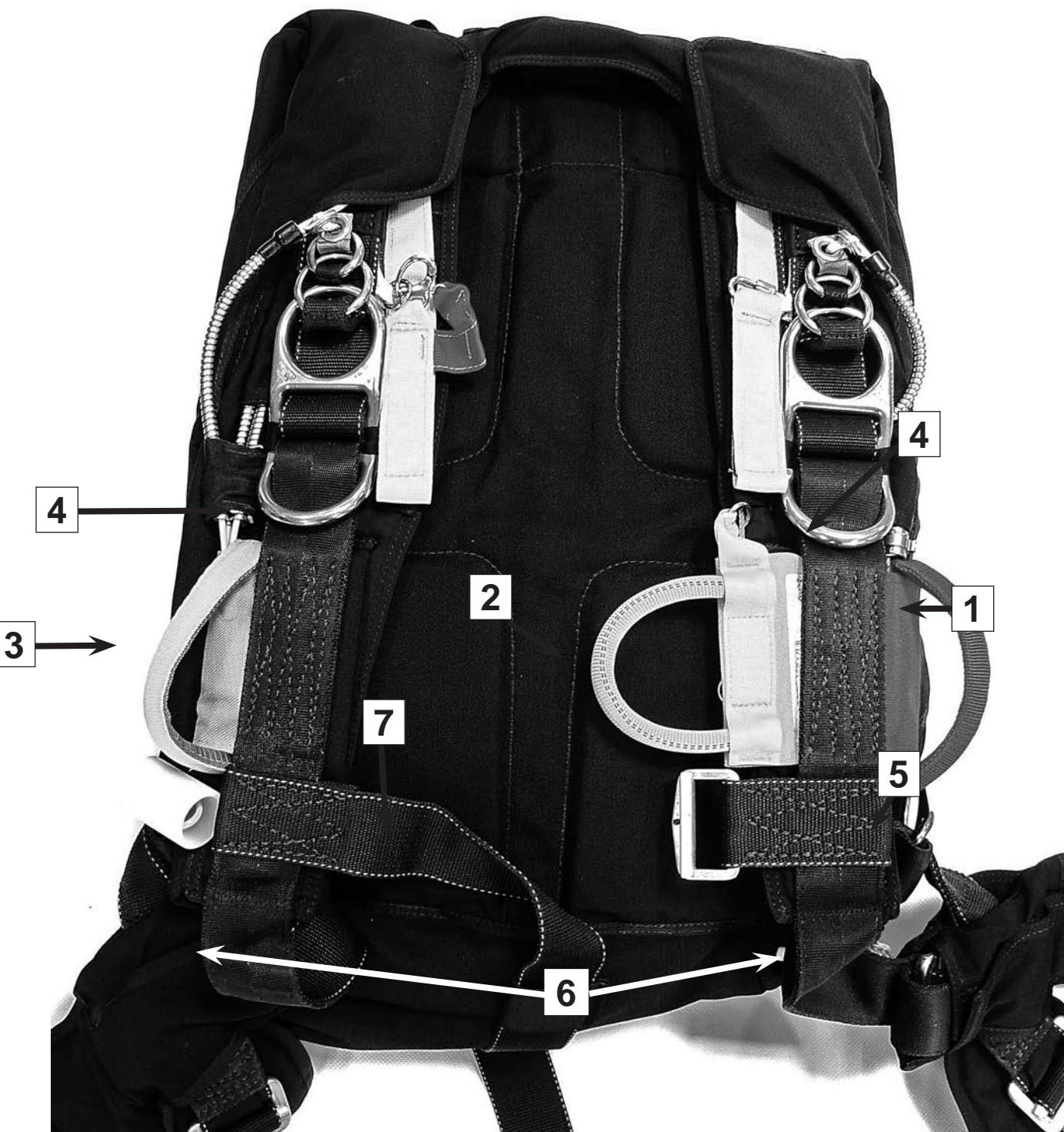
Orienter le câble de la poignée répétiteur secours de manière à positionner l'anneau d'extrémité de câble sous le corps de poignée.
