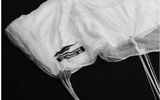
Rouler le bord d'attaque jusqu'à l'alignement du groupe de suspentes A.
