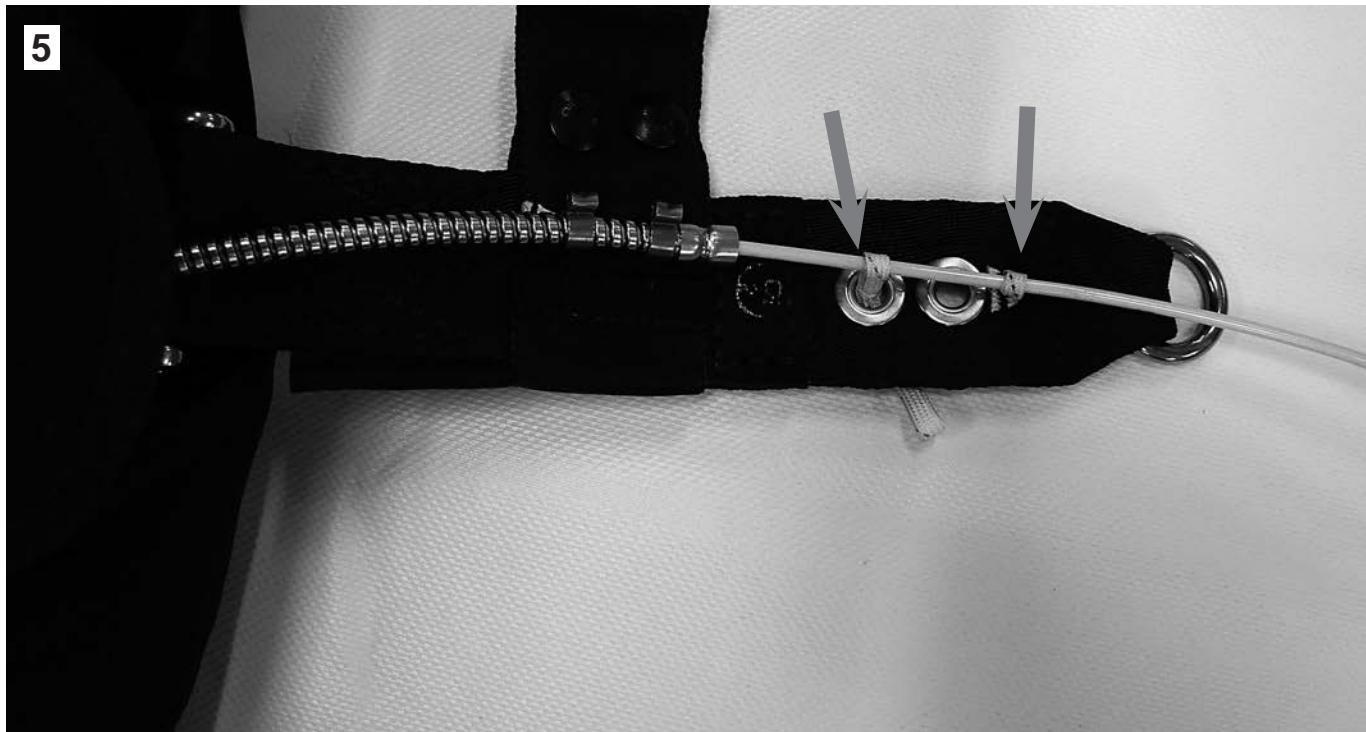
Passer le cable de la poignée commande d'ouverture (CDO) dans le tunnel textil du libérateur RSE. Monter le libérateur 3 anneaux, verrouiller la bouclette avec le cable en l'intraduisant dans le second œillet.
