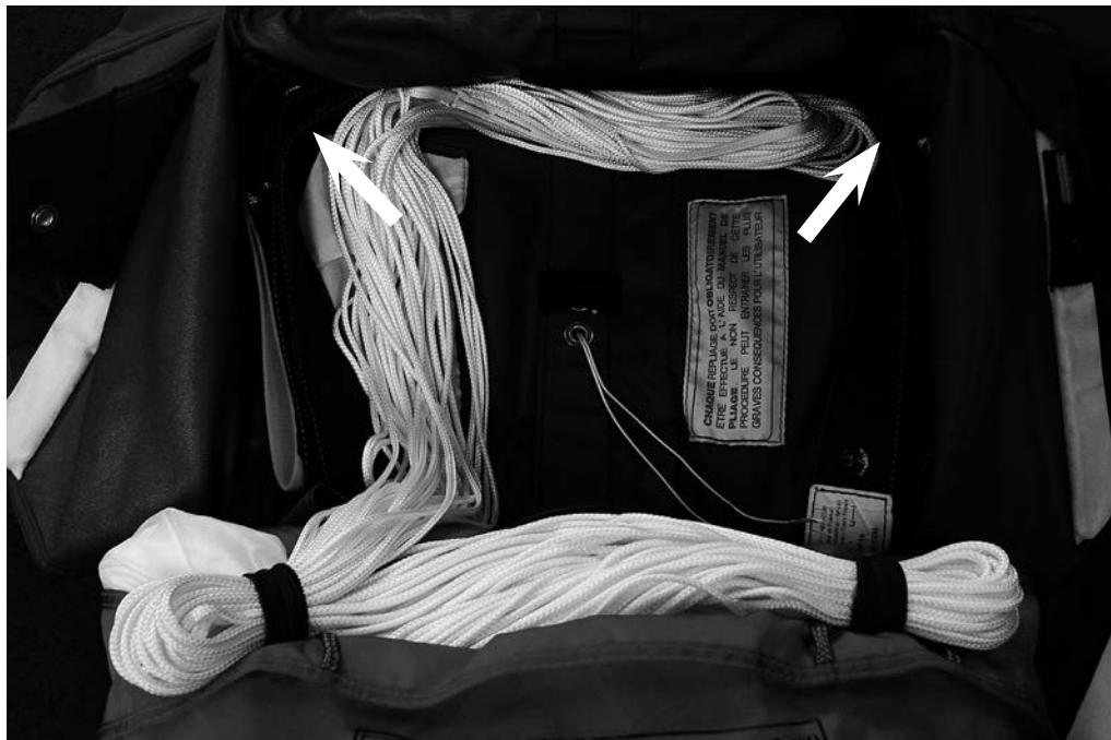
Placer le sac de déploiement à l'intérieur du conteneur de réserve.
