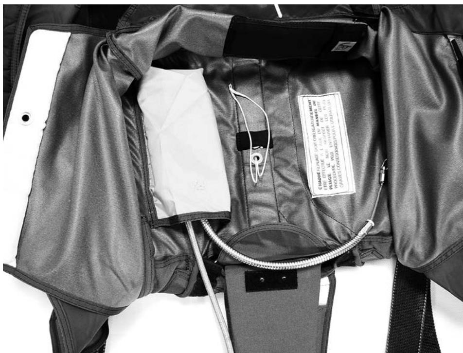
Glisser la gaine du câble de traction de l'ouvreur à l'intérieur de l'encolure, puis fixer son extrémité au rabat supérieur de réserve à l'aide du collier et des deux vis de 4 mm.
