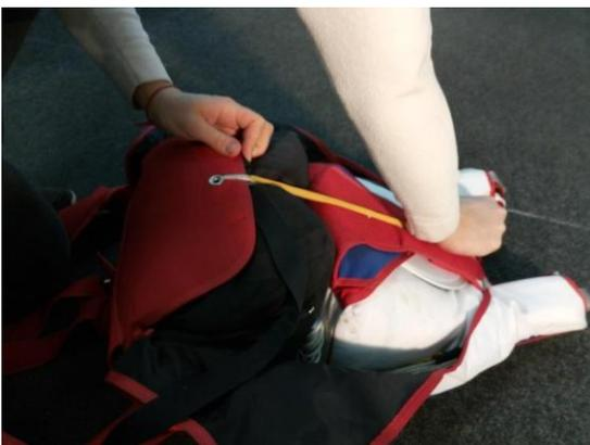
Рисунок 82 - Затяжка нижнего клапана
