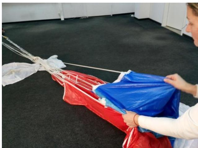
Рисунок 39 - Укладка задней кромки купола, левая сторона
