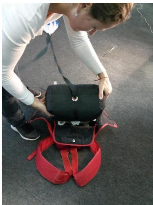
Рисунок 77 - Установка камеры вертикально в отсек ОП
