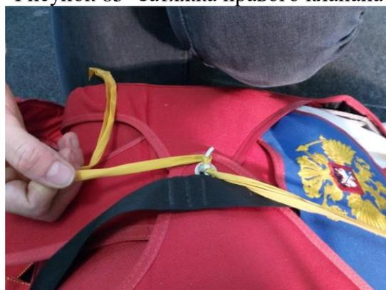
Рисунок 87 - Извлечение ленты - затяжки
