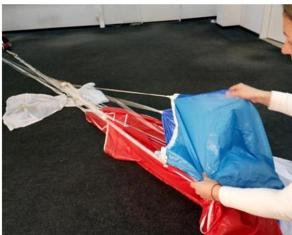
Рисунок 38 - Укладка задней кромки купола, левая сторона
