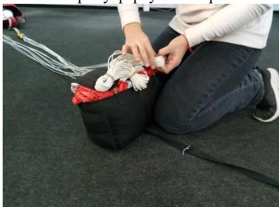
Рисунок 72 - Укладка третьего пучка строп на фартуке
