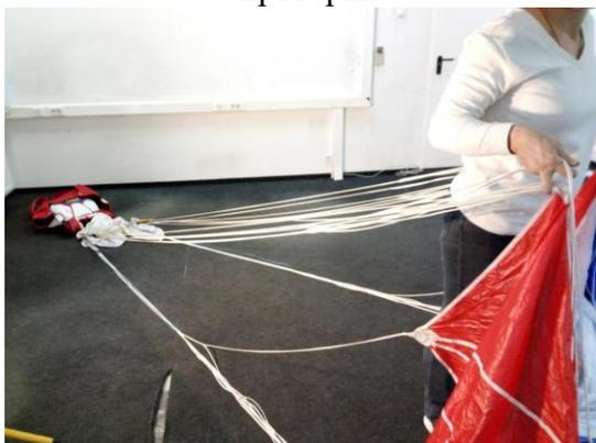
Рисунок 22 - Проверка на деление «верх-низ»
