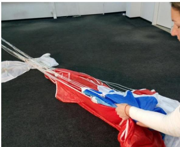
Рисунок 40 - Укладка задней кромки купола, левая сторона
