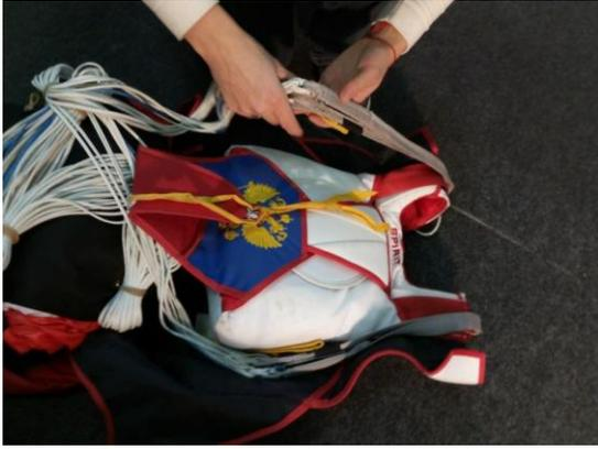
Рисунок 78 - Укладка СК основными звеньями управления к отсеку запасного парашюта
