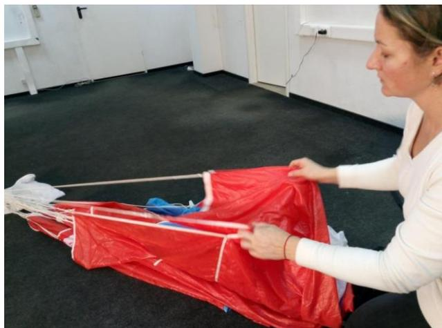
Рисунок 37 - Укладка задней кромки купола - «хвоста», левая сторона
