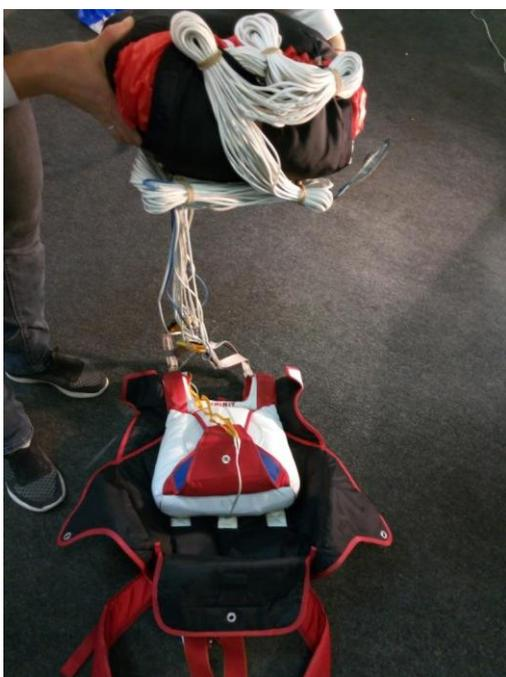
Рисунок 76 - Перенос камеры в отсек ОП
