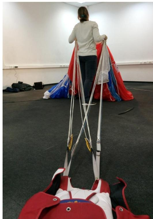
Рисунок 25 - Разложение купола в «профиль», вид сзади
