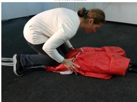
Рисунок 64 - Сворачивание ОП для укладки в камеру
