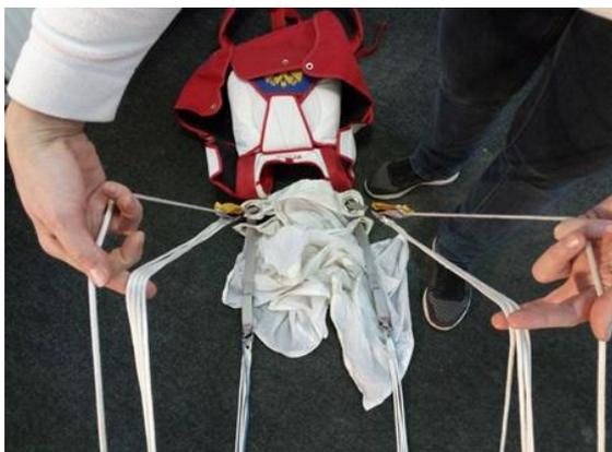
Рисунок 20 - Разделение строп для проверки
