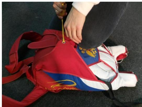
Рисунок 85 - Затяжка правого клапана
