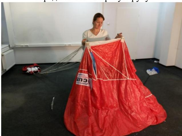
Рисунок 26 - Разложение купола «в профиль», вид переди
