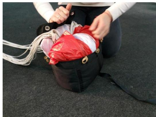
Рисунок 69 - Разделение строп на два ручья
