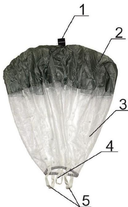
Рисунок 11 - Парашют вытяжной мягкий
