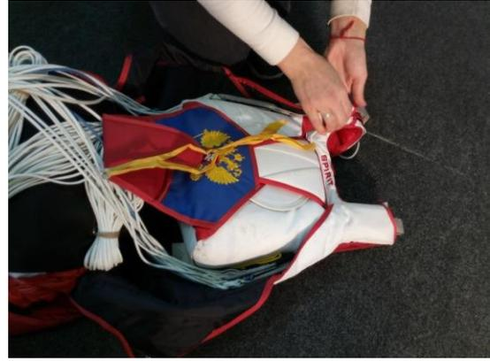
Рисунок 79 - Зачековка предохранительных клапанов
