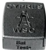
Un transport aérien peut provoquer le déchargement de la pile. Veuillez faire une vérification de la pile après un voyage en avion. Si le contrôle échoue : Retirez la pile et glissez-la à nouveau dans les 10 secondes. Refaite un contrôle de la pile. Si le contrôle échoue, changer la pile.
