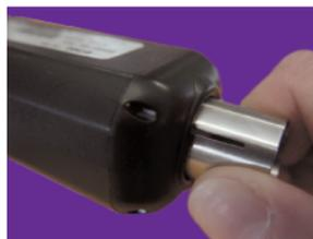
Tenez fermement l'outil, tournez-le dans le sens inverse des aiguilles d'une montre et retirez le filtre. S'il y a de l'eau dans la boîte (derrière le filtre), épongez-la soigneusement avec un tissu doux
