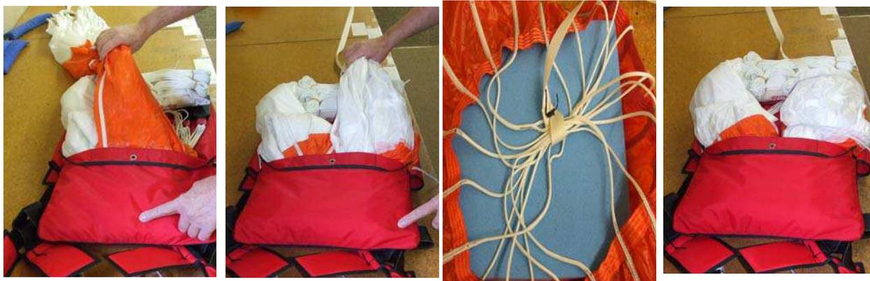
Étape T13 – Vu que le drapeau est placé sur le dessus du sac dans le « Taper Pack », la phase de déploiement se produit grâce à la fermeture par velcros attachés au sommet et aux deux rabats de côté (comme indiqué sur la photo).
