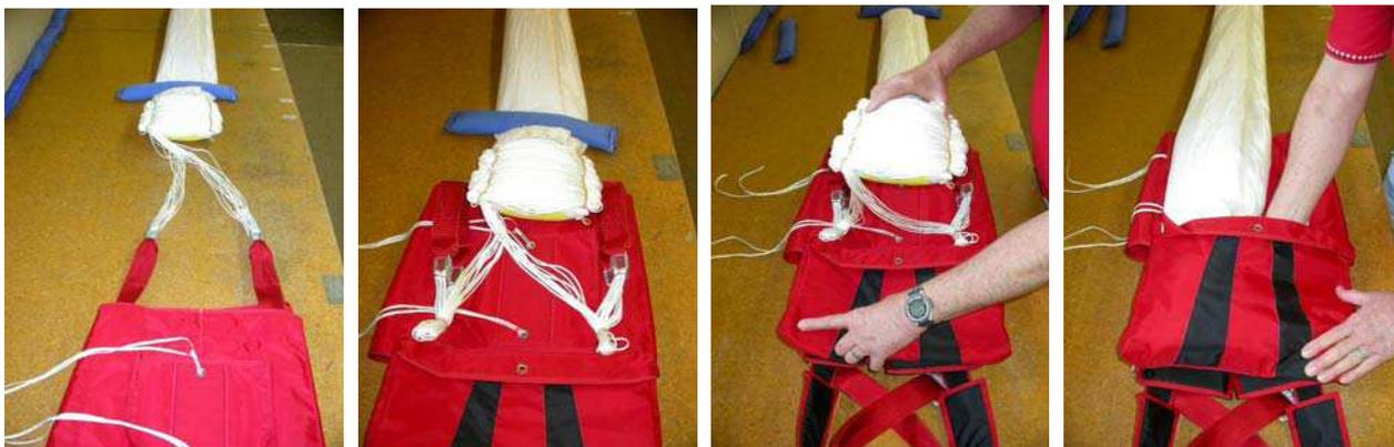
Étape 13 – Positionner la voile pliée vers le côté gauche du sac. Mettre le rabat raidisseur de couverture sur la voile et utiliser un sac lesté pour empêcher la voile de sortir de la poche.
