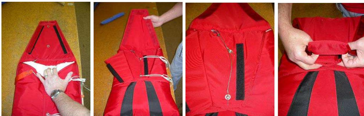
Étape 29 – A présent fermer la bande d'accrochage sur chaque coté du rabat supérieur en l'enroulant en dessous et en l'assemblant avec les « velcro » de fermeture. Éviter tout accroch du tissu de la voile avec la bande agrippante du velcro.
