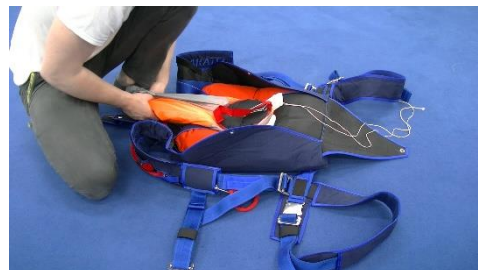
Bild 14.4.3.4 Stoff des Federhilfsschirms nach oben herausführen
