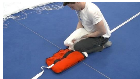
Bild 14.3.3.14 Kappenbündel (rechts) vor der rechten Kammer des Freebags positionieren
