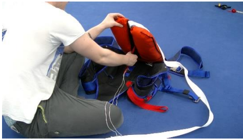
Bild 14.4.1.11 Packband (weiß) in die Packhilfe (rot) einfädeln, Packhilfe nach oben herausziehen
