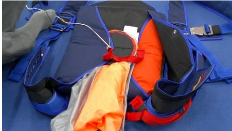
Bild 14.4.3.5 Öse der Klappe 3 über der Loop-Öse positionieren, Loop hindurchführen und mit Vorstecker fixieren
