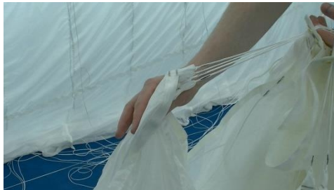
Bild 14.3.2.4 Steuerleinenbündel beidseitig auf freien Verlauf prüfen
