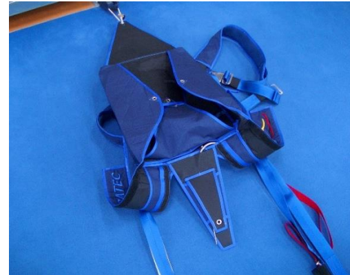
Bild 14.2.4 Gurtzeug/Container an einem Fixpunkt festmachen
