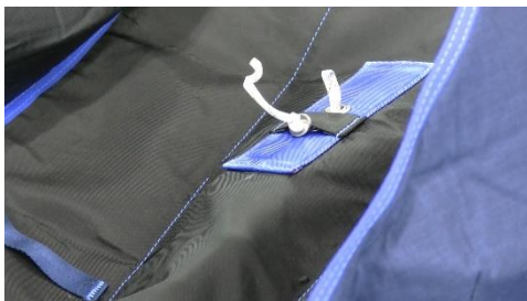
Bild 14.4.1.3 Loop einführen, Scheibe und Knoten vollständig unter das Gummiband ziehen
