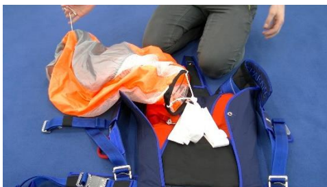
Bild 14.4.3.1 Rest der Hilfsschirmverbindungsleine gleichmäßig falten und je eine Hälfte links und rechts des Loops in einem „V“ anordnen, Packband durch den Federhilfsschirm führen
