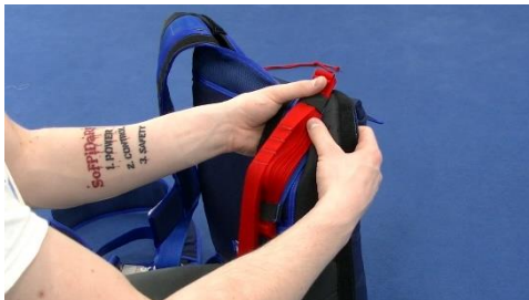
Bild 14.4.3.9 Aufziehleine über dem linken Tragegurt ordnen und Klappe bündig verschließen
