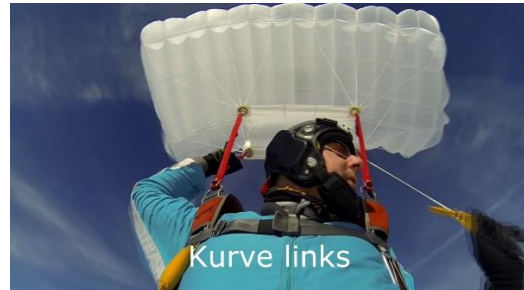
Bild 7.2.2.2 Ziehen der linken Steuerschlaufe: Kurve links
