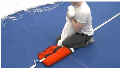
Bild 14.3.3.13 Kappenbündel (rechts) aufnehmen, dabei müssen alle Vorderkanten der Zellen zu sehen sein; Kopf umfalten
