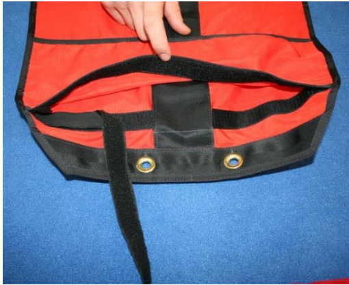
Bild 14.2.1 Die Rauseite des Klett am Freebag mit einem Klettband abdecken.
