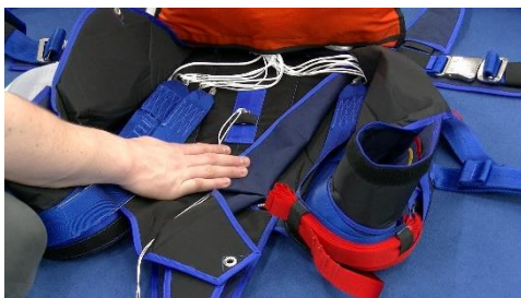
Bild 14.4.1.7 Tragegurte links verstauen
