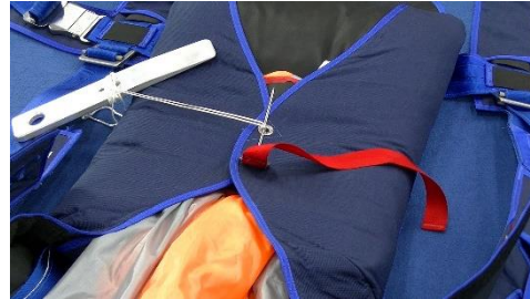
Bild 14.4.3.6 Öse der Klappe 4 über der Loop-Öse positionieren, Loop hindurchführen und mit Vorstecker fixieren
