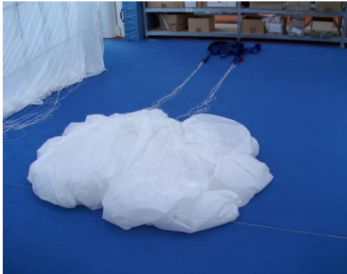
Bild 14.2.3 Gurtzeug/Container und Fallschirmkappe auslegen, Kontrollieren der Kappe
