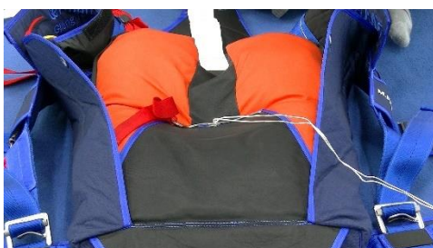
Bild 14.4.2.3 Loop durch die Klappe 1 ziehen und mit Vorstecker fixieren
