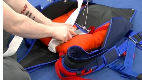
Bild 14.4.2.6 Die drei Enden der Hilfsschirmverbindungsleine am Loop vorsichtig mit dem Packhilfe“ unter die Klappe 1 schieben
