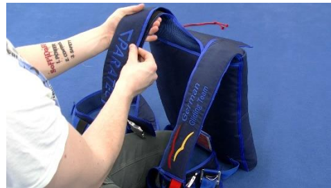
Bild 14.4.3.10 Klappe der rechten Tragegurte bündig verschließen
