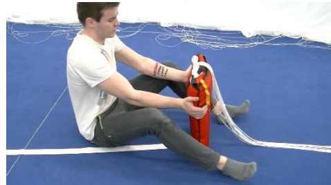
Bild 14.3.3.22 Fixierung des Gurtzeugs lösen (Bild 14.2.4) Den gepackten Freebag auf die Rückseite wenden
