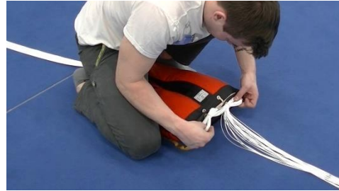
Bild 14.3.3.20 Die Leinenbündel durch das Packgummi ziehen und Freebag mit einem Fangleineschlag (links) verschließen
