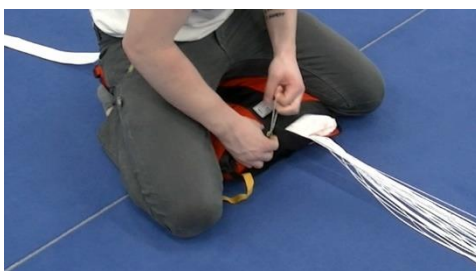
Bild 14.3.3.17 Rechte Seite des Packgummis durch die rechte Öse führen
