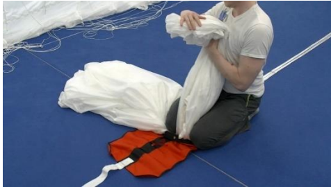
Bild 14.3.3.9 Kopf des Kappenbündels (links) umfalten
