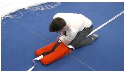
Bild 14.3.3.15 Kappenbündel (rechts) Kopf voran vollständig in die rechte Kammer des Freebags schieben
