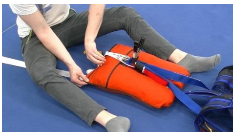
Bild 14.3.3.25 Abdeck-Klettband entfernen, Tasche verschließen, dabei die Leinen und Klettflächen getrennt halten
