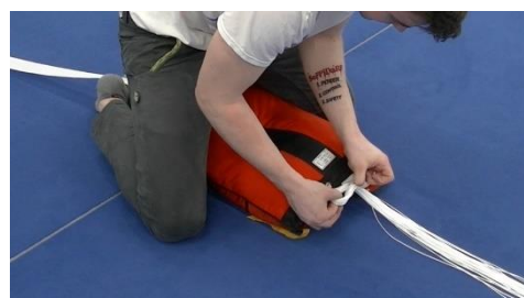
Bild 14.3.3.18 Die Leinenbündel durch das Packgummi ziehen und Freebag mit einem Fangleineschlag (rechts) verschließen
