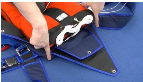
Bild 14.4.2.1 Ecken des Freebags und des Containers auf eine Höhe bringen
