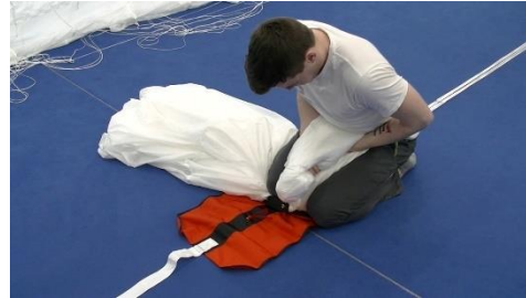
Bild 14.3.3.10 Kappenbündel (links) vor der linken Kammer des Freebags positionieren
