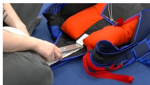
Bild 14.4.2.4 Den ersten Teil der Hilfsschirmverbindungsleine mit dem „Packholz“ bündig unter den Freebag schieben
