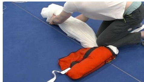
Bild 14.3.3.12 Sorgsam die Luft aus dem rechten Kappenbündel pressen, dabei den Stoff glätten
