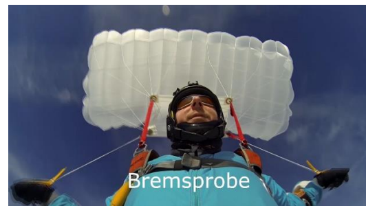
Bild 7.2.1.2 Vorbremse gelöst, Bremsprobe durchführen
