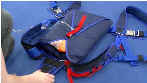
Bild 14.4.3.7 Öse der Klappe 5 über der Loop-Öse positionieren, Loop hindurchführen und mit Vorstecker fixieren, Kappe des Federhilfsschirms locker einrollen und im Container verstauen
