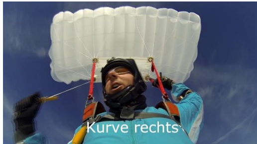
Bild 7.2.2.1 Ziehen der rechten Steuerschlaufe: Kurve rechts
