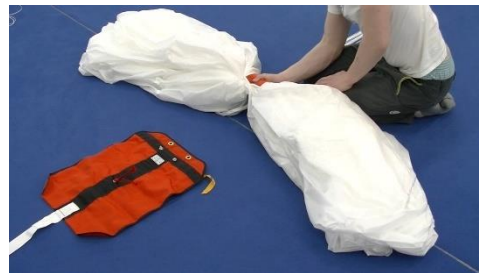
Bild 14.3.3.6 Unteren Teil der Mittelzelle auffächern und unterschieben, Mittelzelle komprimieren
