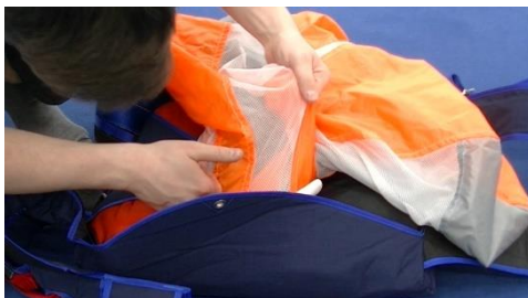
Bild 14.4.3.3 Eingeklemmten Stoff zu allen Seiten herausziehen (nur an den Nähten ziehen)
