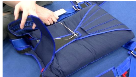
Bild 14.4.3.8 Öse der Klappe 6 über der Loop-Öse positionieren, Loop hindurchführen und mit Verschlusspin fixieren
