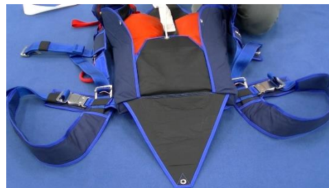
Bild 14.4.2.2 Verstauen des Freebags im Container
