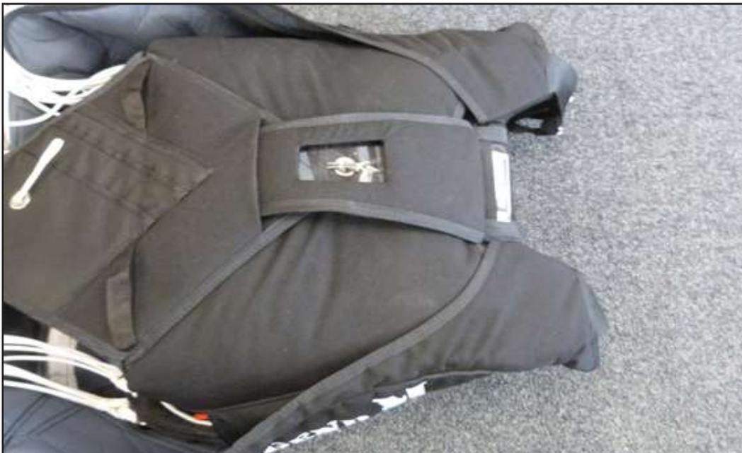
Disposez les suspentes à l'extérieur des protections situées aux angles du conteneur de secours.
