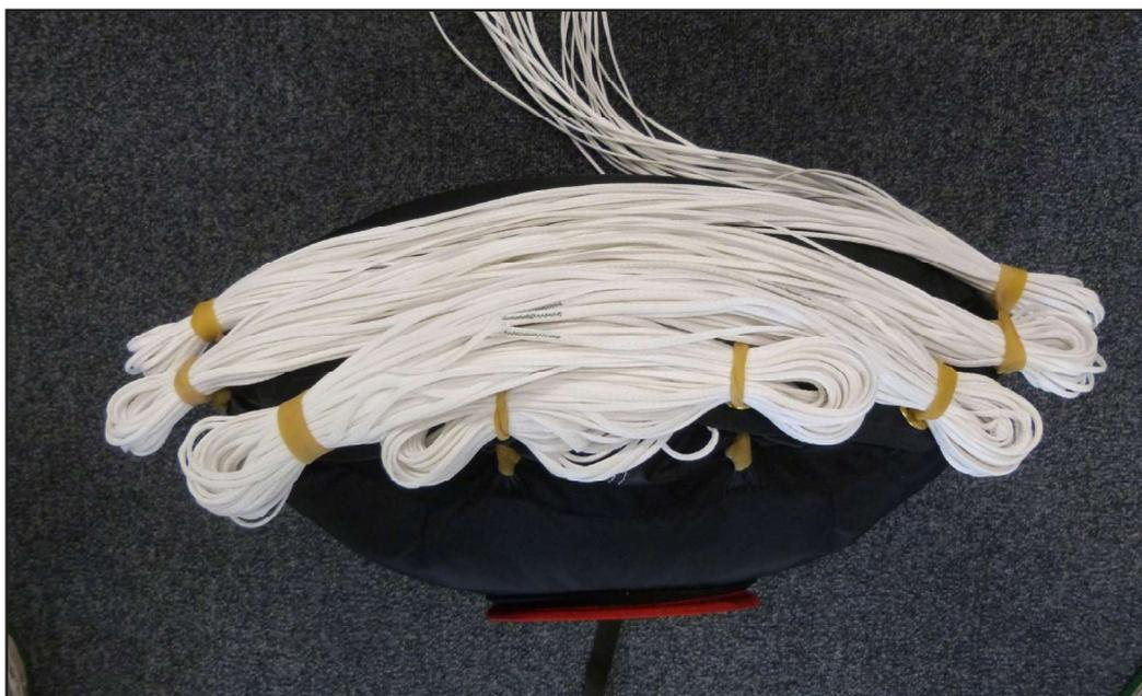
Continuez le lovage des suspentes sur le POD et laissez environ 60 cm de suspentes libres entre le dernier lovage et le sommet des élévateurs.(Fig 54)
