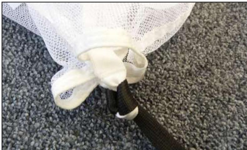
Passez la patte d'attache d'extracteur de l'extrados central de la voilure principale à travers l'oeillet de fond de POD principal.
