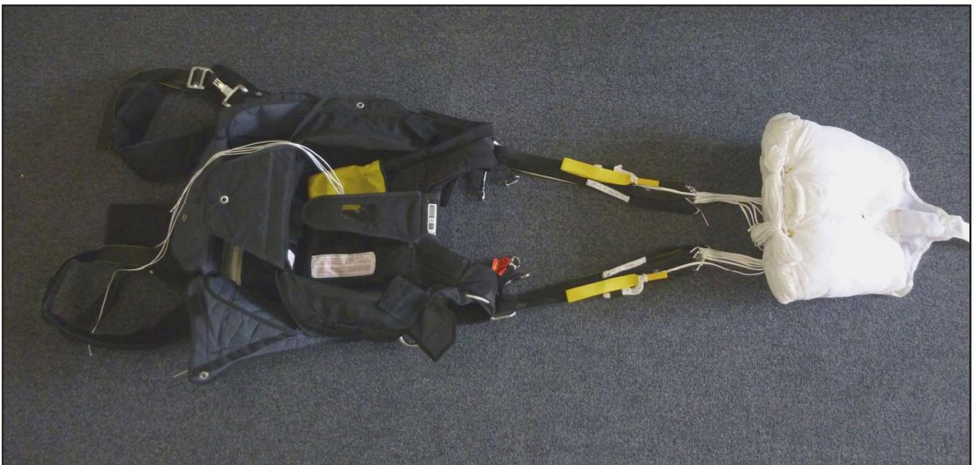
Disposez les éleveurs à plat sur le fond du conteneur de secours et passez la drisse provisoire de fermeture
