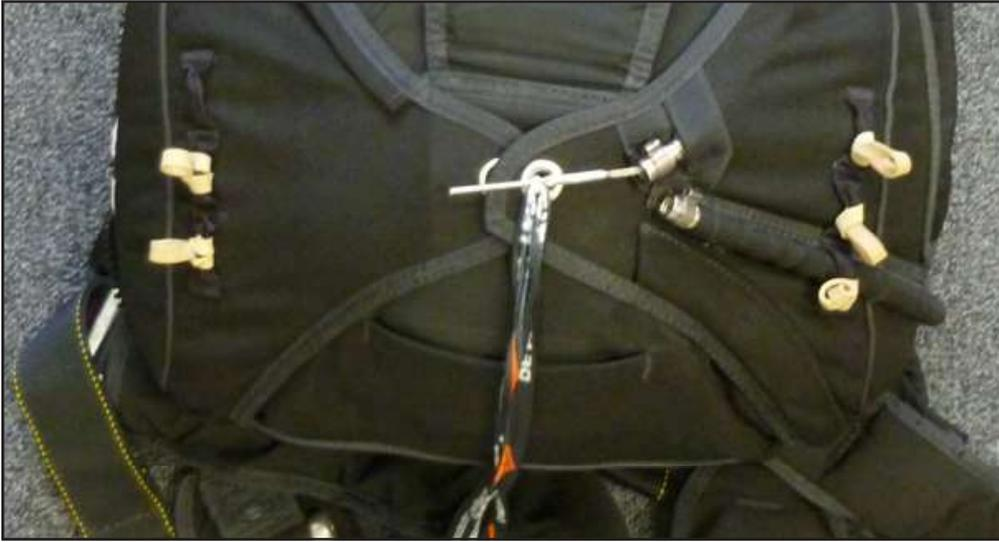
**L'AIGUILLE DOIT ÊTRE AU PLUS PRES DE L'EXTREMITÉ DE LA GAINE ET LE CÂBLE DE LA POIGNEE A L'INTERIEUR DE LA GAINE POUR EVITER TOUT BLOCAGE**
