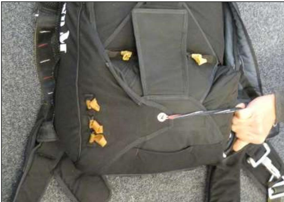
Fermez le rabat latéral droit puis verrouillez le conteneur à l'aide de l'aiguille de la poignée de déclenchement principal VD, puis rétirer la drisse provisoire.
