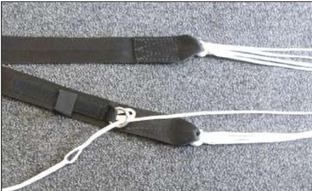
5.3.5 - Installation des 1/2 freins plats sur les élévateurs V3:
