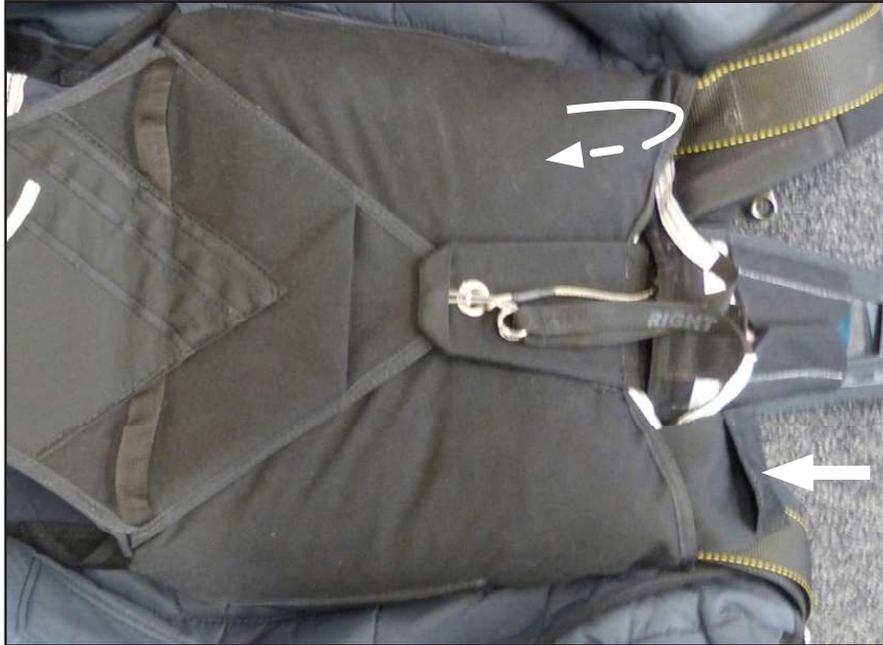
Contrôlez que le cheminement des sangles LOR 2 soit libre en faisant pivoter les élévateurs de secours une fois le POD mis en place dans le conteneur de secours.
