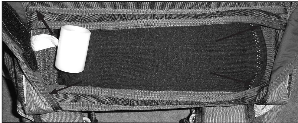
Mettre la voilure en POD et fermer le conteneur principal à l'identique que l'option Hand deploy.
