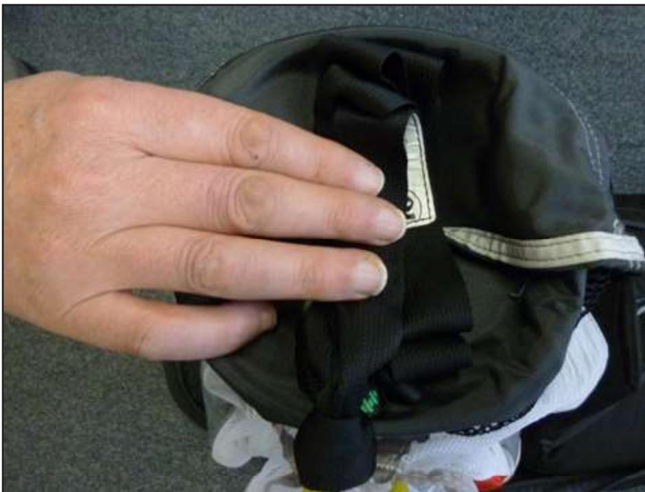
Placer l'extracteur souple sur la drisse puis plier le sur la base supérieur.
