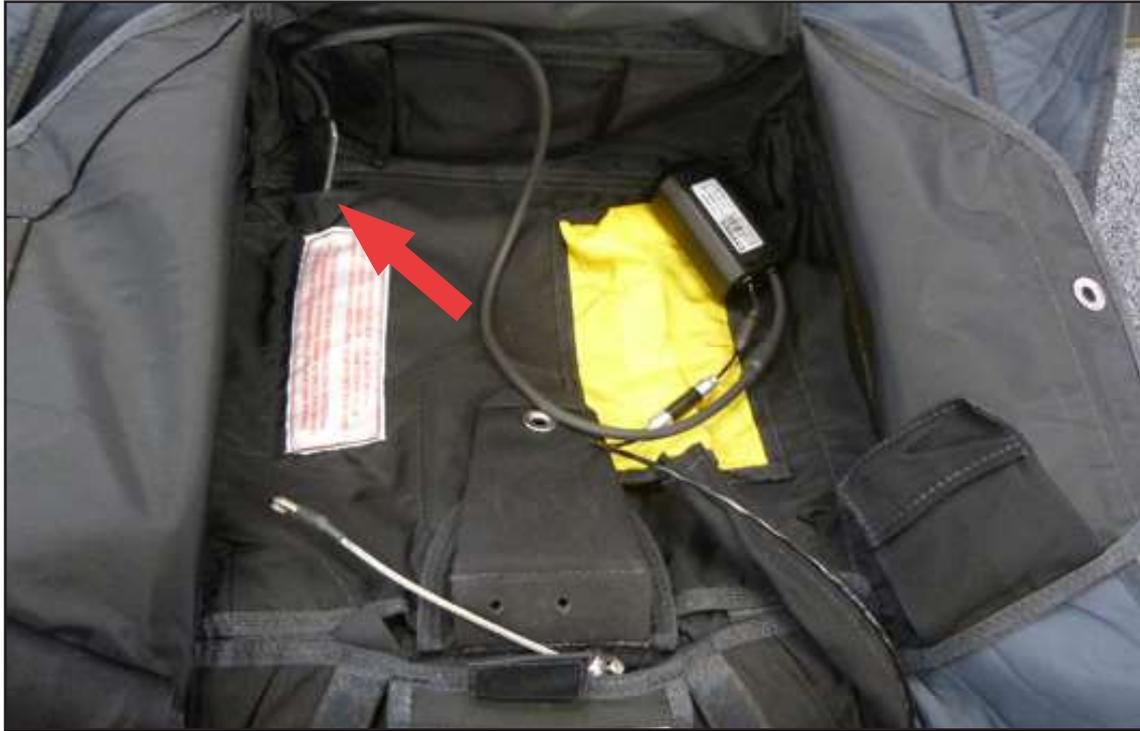
Faites passer le boîtier de commande dans le tunnel du conteneur de secours prévu à cet effet.
