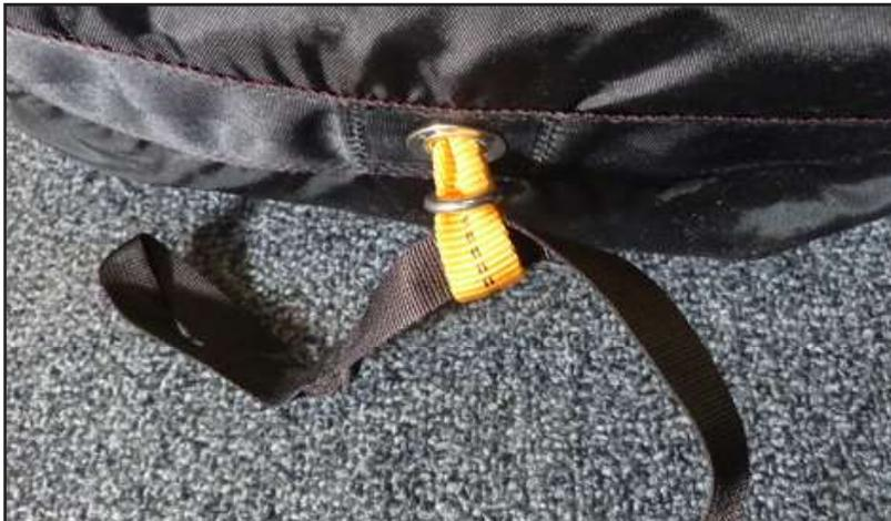
Connectez l'ensemble drisse et extracteur précédemment monté à la patte d'attache avec un noeud en "tête d'allouette".
