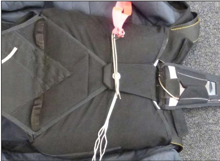
Introduisez chaque broche respectivement dans la boucle du câble de la poignée secours et dans chaque boucle de la bouclette double.
