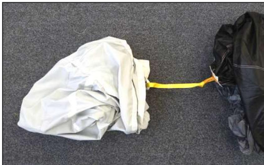
Passez la boucle opposé à l'aiguille courbe de la drisse hand deploy dans la boucle du ruban central de l'extracteur et sous les deux croisillons des rubans extérieurs de l'extracteur.
