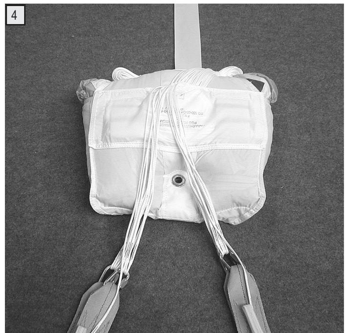
**2.6 - Fermeture du conteneur de secours :****2.6 - Reserve container closing:****2.6.1 - Mise en place des sangles LOR 2:****2.6.1 - LOR 2 System instalation:**
