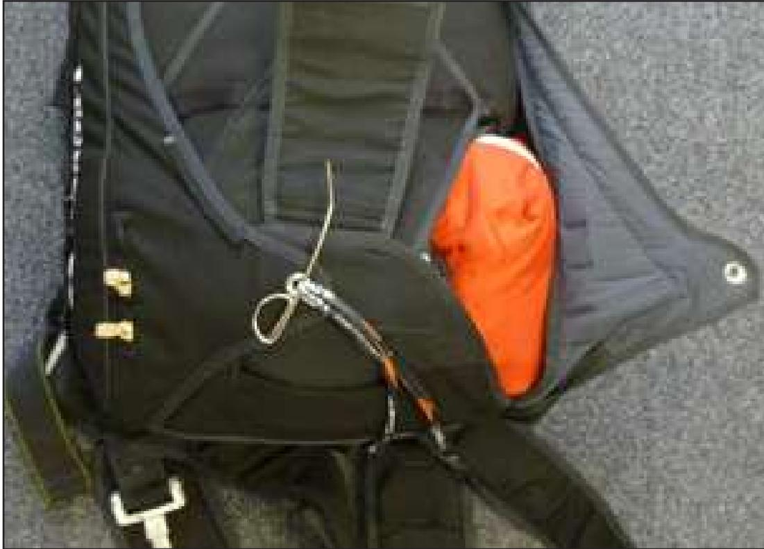
Fermez le rabat droit puis passez le câble de la poignée de déclenchement dans la boucle d'extrémité de la poignée répéteur PAC ( SI OPTION) puis fermez le conteneur à l'aide du câble plastique de la poignée de déclenchement principal.
