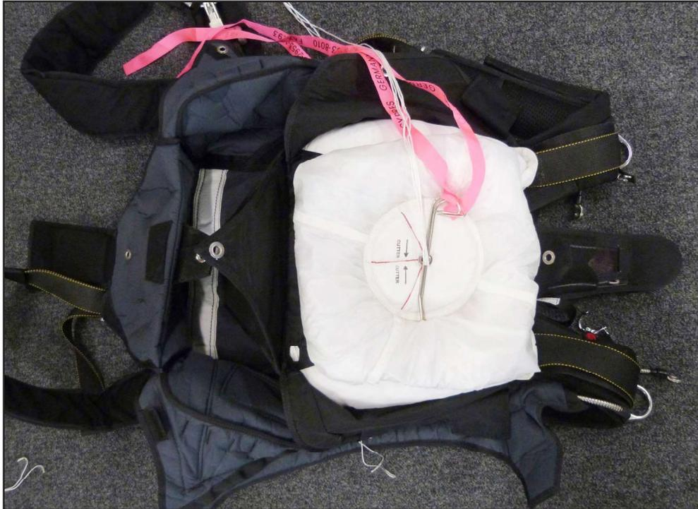
Passez la drisse provisoire dans l'oeillet du rabat latéral gauche et bloquez à l'aide des aiguilles provisoires.
