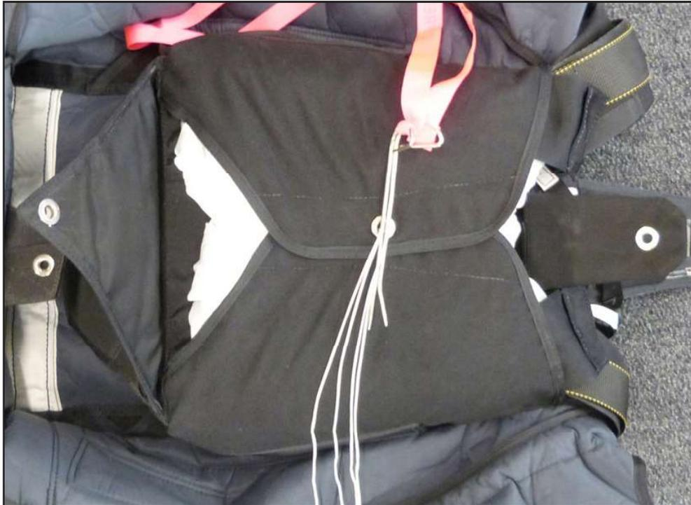
Passez la drisse provisoire dans l'oeillet du rabat central et bloquez à l'aide des aiguilles provisoires..
