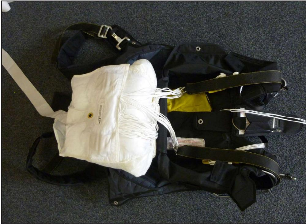
Positionnez le POD dans le conteneur de secours en remplissant les angles inférieurs du conteneur.
