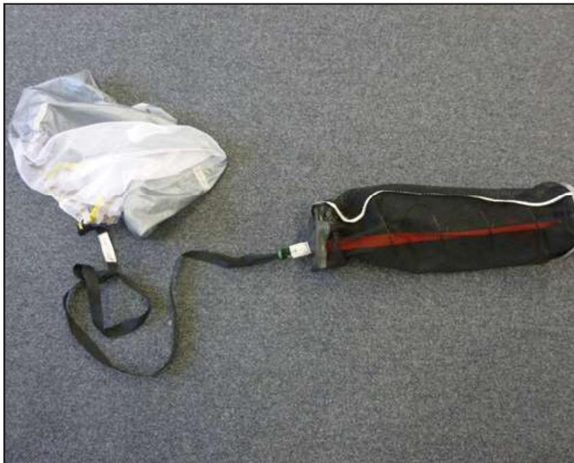
Passer la patte d'attache de la voile principale à travers l'oeillet du POD principal.
