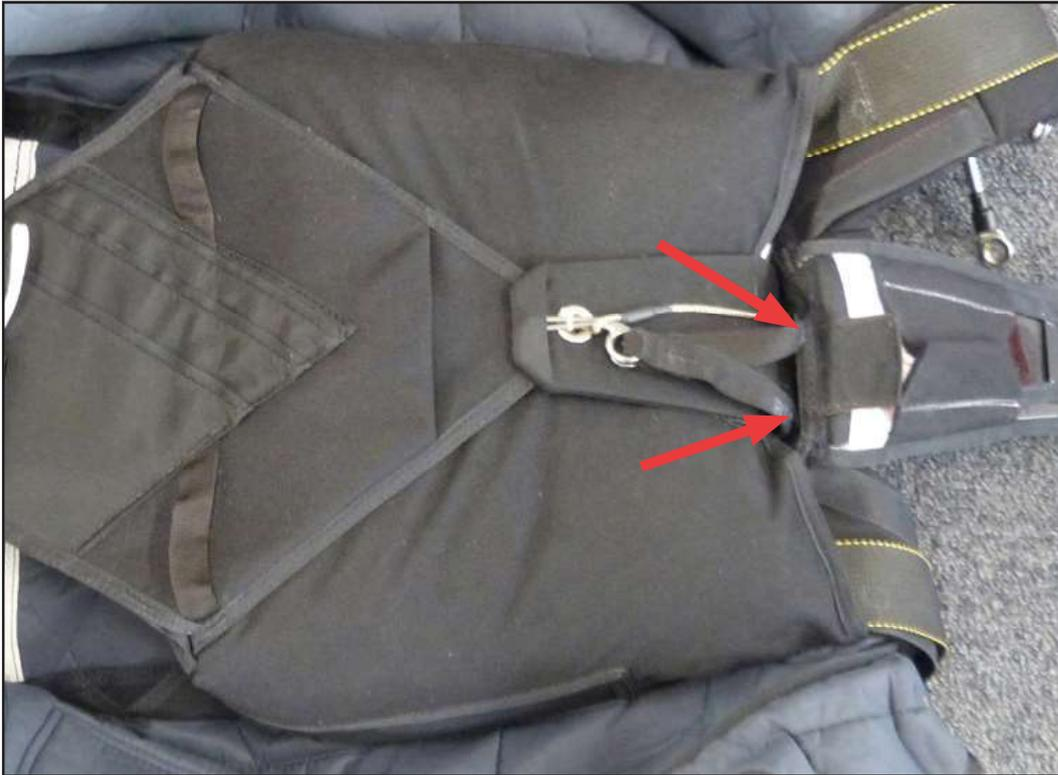
Effectuez le plombage des broches de fermeture en évitant de positionner le plomb au niveau de la bouclette et de l'oeillet.
