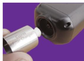
Prenez alors l'outil pour changer les filtres par l'extrémité non fendue, puis introduisez doucement le filtre, sans l'incliner, dans le logement prévu de l'unité de travail. Tournez l'outil dans le sens des aiguilles d'une montre, au début il y a une petite résistance. Continuez de tourner l'outil jusqu'à ce qu'il glisse sur le filtre (le filtre s'arrête de tourner mais l'outil peut encore tourner). Enlever l'outil du filtre en le tirant bien dans l'axe.
