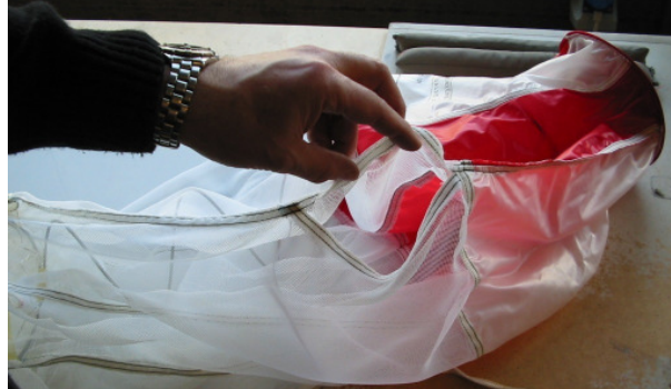
Abb. 13 Öffnung zum einfädeln der Hilfsschirmleine
