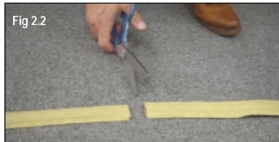
**NOTE:** Soyez certain que sont vraiment aiguisés. Nous suggérons de s'entraîner sur une section du Kevlar (en dessous le disque). La coupure sera plus nette quand le Kevlar est sous tension.
