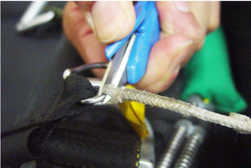
Second, coupez le reste de suspente dacron attachant la boule de cristal à l'attache RSL.
