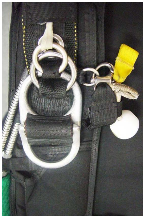
Vue d'un RSL standard Sigma avec la Boule de cristal
