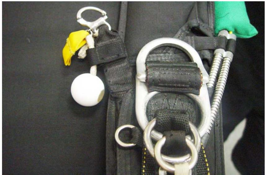
Pour retirer la boule de cristal coupez le morceau de suspente dacron 600 connectant la boule de cristal à l'attache RSL
